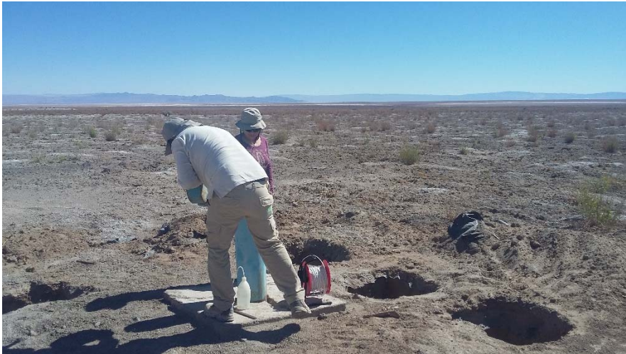
Figura 6: Equipo de SQM realizando mediciones de niveles piezométricos, como parte del Plan de Contingencia de SQM. De izquierda a derecha pozo L3-15.
