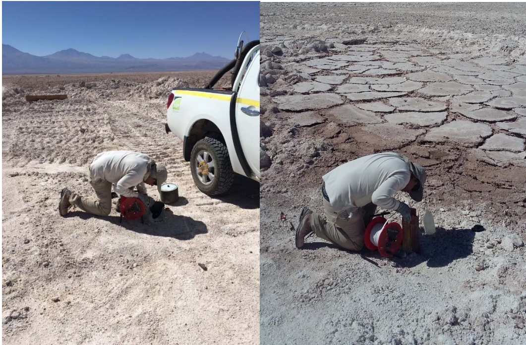
Figura 1: Equipo de SQM realizando mediciones de niveles piezométricos, como parte del Plan de Contingencia de SQM. De izquierda a derecha pozo L1-5 y reglilla L1-G4.
