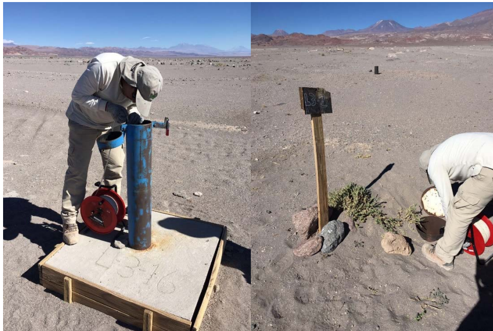
Figura 7: Equipo de SQM realizando mediciones de niveles piezométricos, como parte del Plan de Contingencia de SQM. De izquierda a derecha pozos L3-16 y L3-2.
