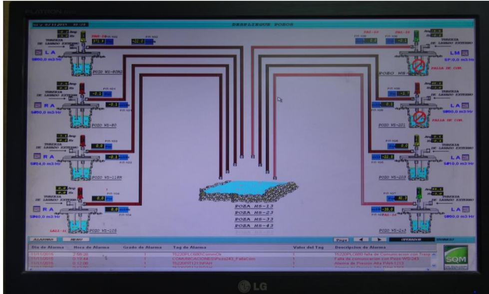
Figura 5: Controlador de sistema de extracción de salmuera pozos WS que alimentan piscinas de concentración área MOP II y SOP.
