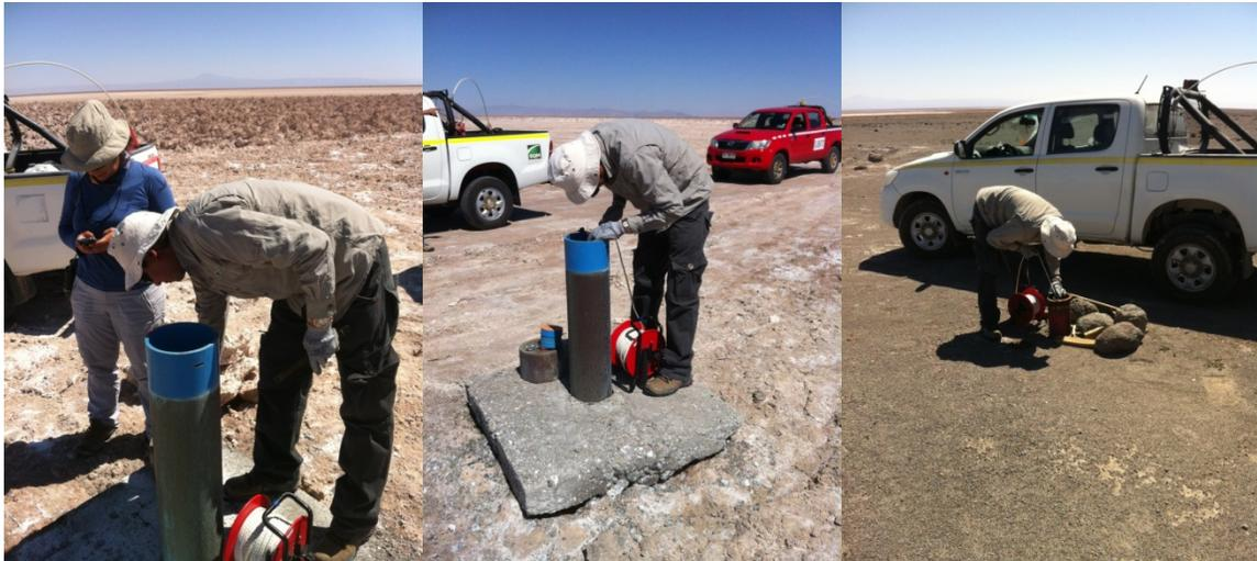
*Figura 3: Equipo de SQM realizando mediciones de niveles piezométricos, como parte del Plan de Contingencia de SQM. De izquierda a derecha pozos L4-11, L4-15 y L5-2.*
