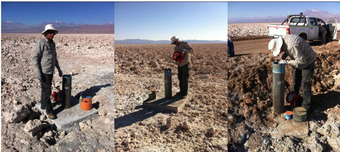
*Figura 4: Equipo de SQM realizando mediciones de niveles piezométricos, como parte del Plan de Contingencia de SQM. De izquierda a derecha pozos Cuña 7 y L10-7 y L10-15.*
