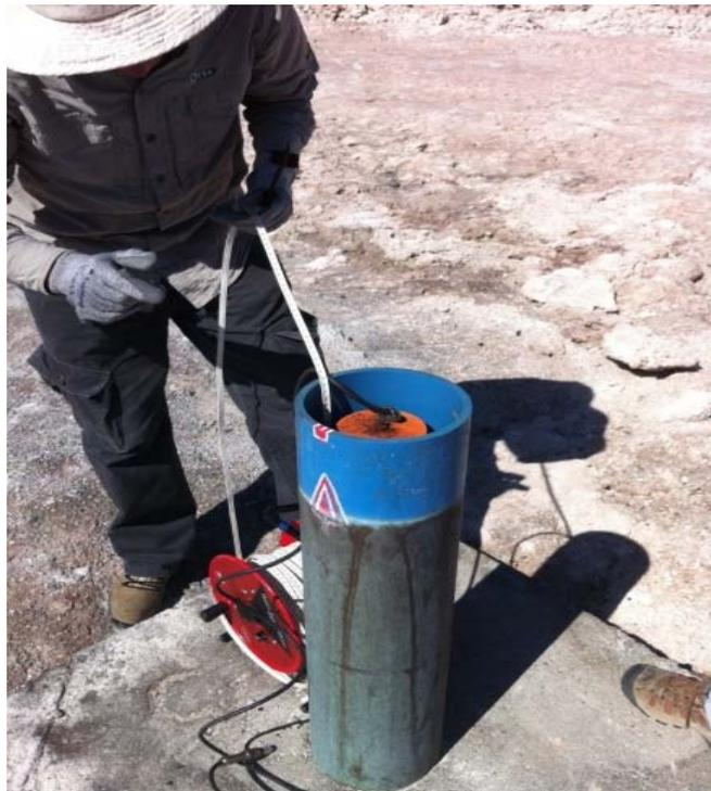
*Figura 2: Equipo de SQM realizando mediciones de niveles piezométricos, como parte del Plan de Contingencia de SQM. Pozo P2-5.*
