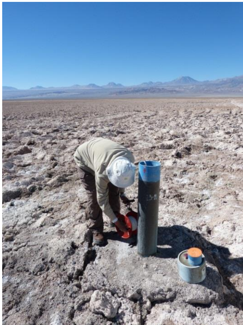
Figura 3: Equipo de SQM realizando medición de nivel piezométrico como parte del monitoreo de PSAH en el pozo L3-11.
