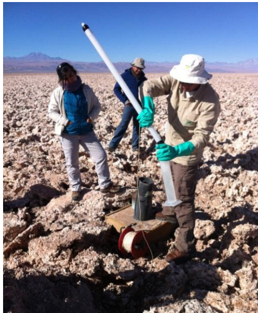
Figura 1: Equipo de SQM realizando medición de nivel piezométrico, de parámetros físico químico in situ, y muestreos de calidad de agua como parte del monitoreo de PSAH en el pozo L2-5
