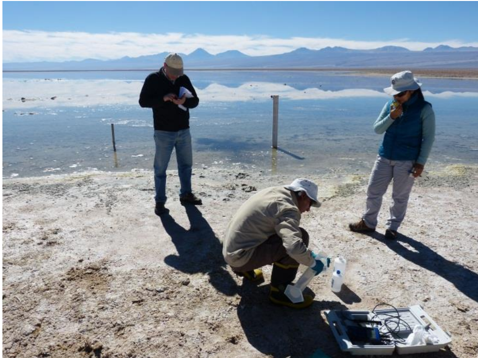
Figura 2: Equipo de SQM realizando medición de nivel de reglilla, de parámetros físico químicos in situ, y muestreos de calidad de agua en la reglilla Chaxas.
