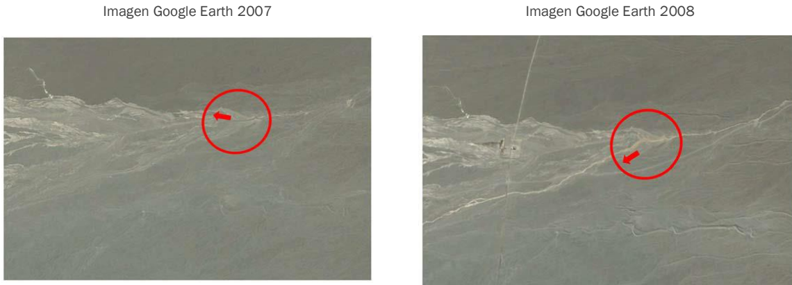
Figura 6-23. Modificación de los escurrimientos superficiales en el sector de Camar
