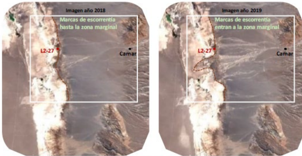
Figura 3-4: Imágenes satelitales de los años 2018 y 2019 mostrando la quebrada Camar junto a las marcas de escorrentía y erosión ocasionadas por las lluvias intensas ocurridas en enero y febrero de 2019
