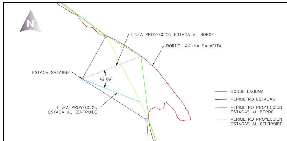
Figura N°3. Comparación de línea de proyección desde estaca CH8 hasta borde de laguna (metodología SQM) con línea de proyección desde estaca CH8 al centroide (metodología CONAF) en laguna Saladita.
