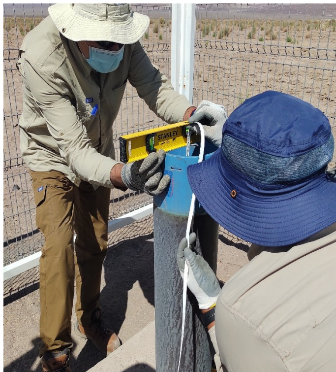
Figura 9: Medición de nivel piezométrico en pozo 1027 (23 de noviembre de 2021).
