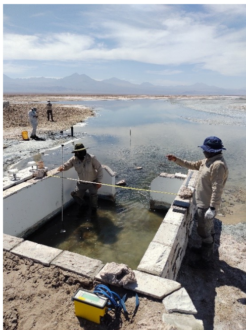
Figura 3: Medición de aforo de caudal en Puente San Luis (23 de noviembre de 2021).
