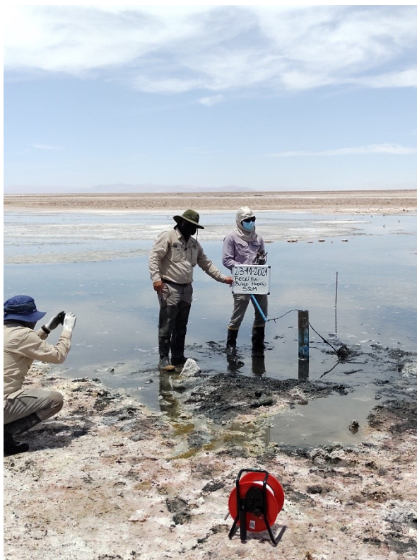
Figura 5: Mantenimiento de habilitación, instalación sensor multiparamétrico y medición de nivel en Reglilla Burro Muerto – SQM (23 de noviembre de 2021).
