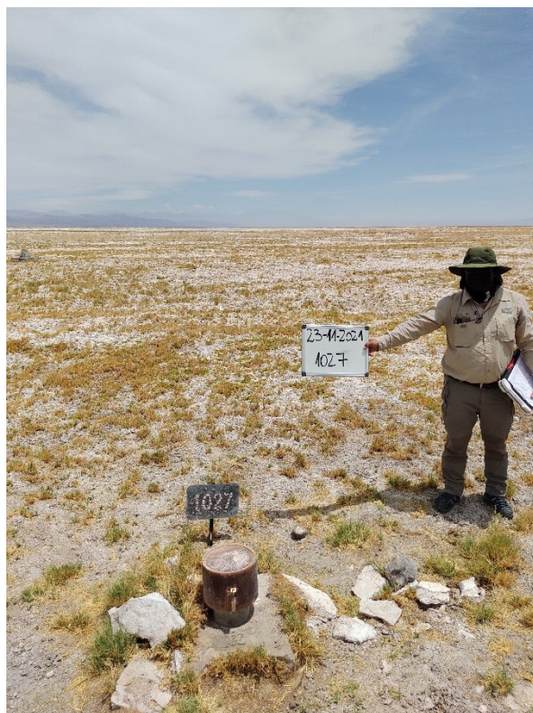
Figura 9: Medición de nivel piezométrico en pozo 1027 (23 de noviembre de 2021).
