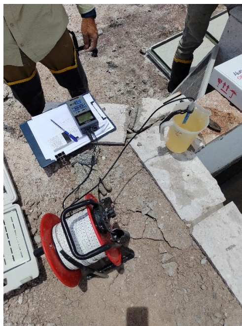
Figura 6: Toma de muestra de agua y registro de parámetros in-situ en Reglilla Burro Muerto (23 de noviembre de 2021).
