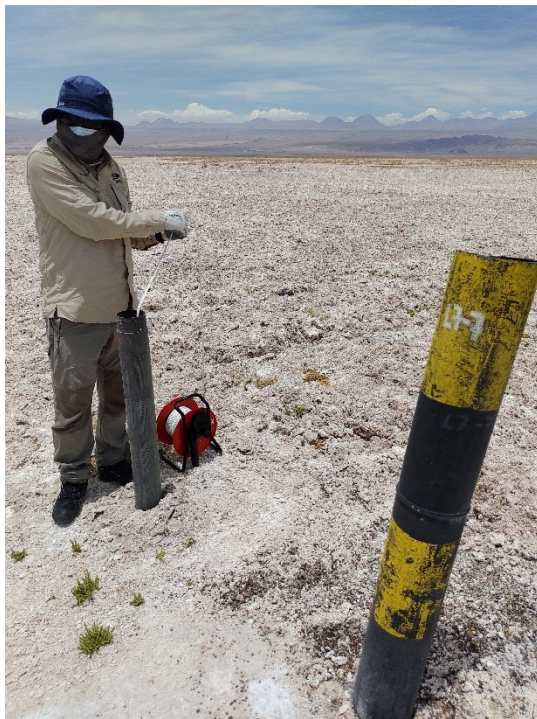
Figura 7: Medición de nivel piezométrico en pozo L7-7 (23 de noviembre de 2021).
