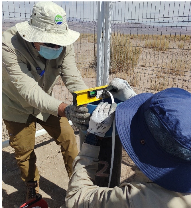
Figura 11: Medición de nivel piezométrico en pozo L9-2 (23 de noviembre de 2021).
