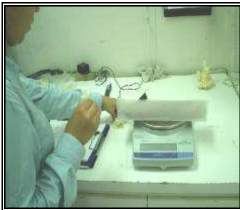
Etapa C: Pesado de muestras húmedas. Balanza de precisión.
