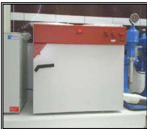
Paso D: Secado y pesado de muestras secas. Estufa con circulación de aire utilizada para secar las muestras.
