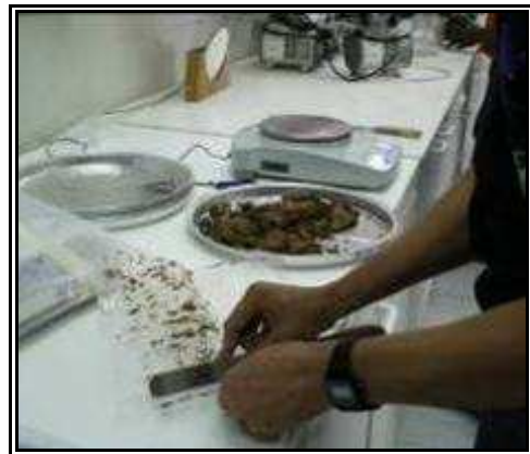
Etapa D: Secado y pesado de muestras secas. Extracción de la muestra de suelo con espátula.
