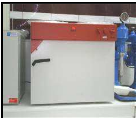
Etapa D: Secado y pesado de muestras secas. Estufa con circulación de aire utilizada para secar las muestras.
