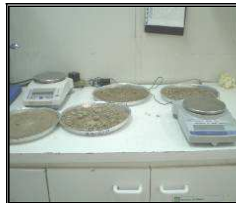
Etapa D: Secado y pesado de muestras secas. Muestras secas en proceso de pesado.
