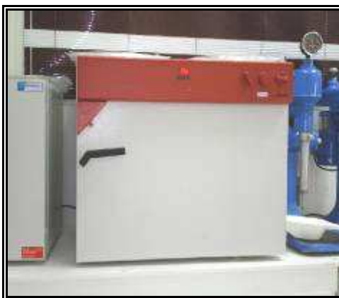
Estufa con circulación de aire utilizada para secar las muestras.
