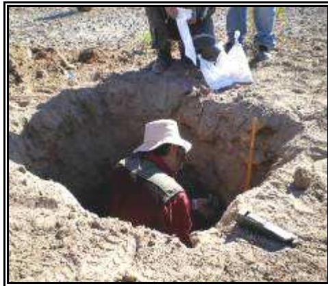
Extracción de muestras calicatas
