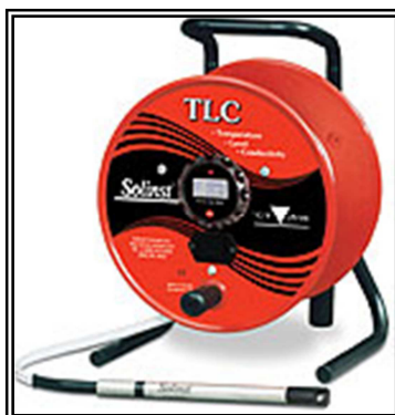
FIGURA 2.3-1 METODOLOGÍA PARA LA MEDICIÓN DE PROFUNDIDAD DE LA NAPA
