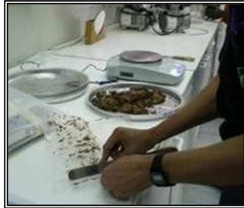
Extracción de la muestra de suelo y preparación para su secado.
