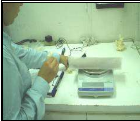
Pesaje de muestras húmedas con balanza de precisión.
