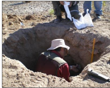
Extracción de muestras calicatas
