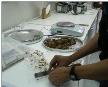
Extracción de la muestra de suelo y preparación para su secado.
