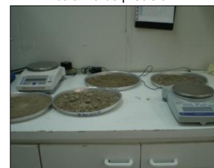
Muestras secas en proceso de pesaje
