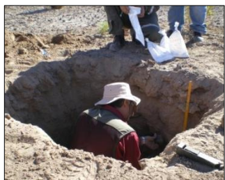
Extracción de muestras calicatas
