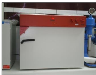
Estufa con circulación de aire utilizada para secar las muestras
