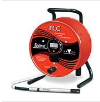
Figura 4-5. Pozómetro utilizado para la medición de profundidad de la napa.
