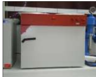
Estufa con circulación de aire utilizada para secar las muestras
