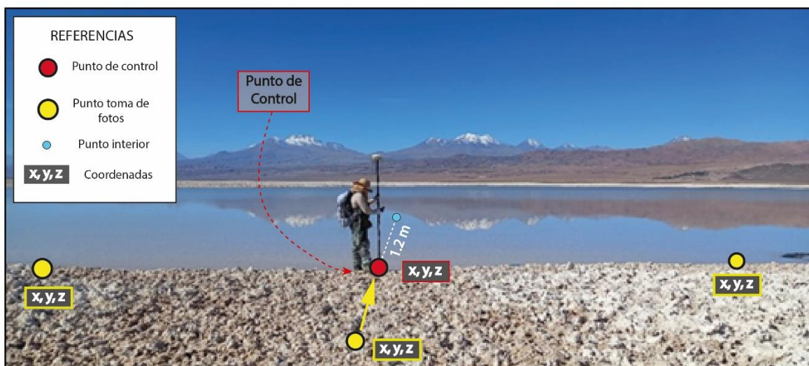
Figura 1: Ejemplo de toma de puntos de control en bordes de superficies lacustres.
