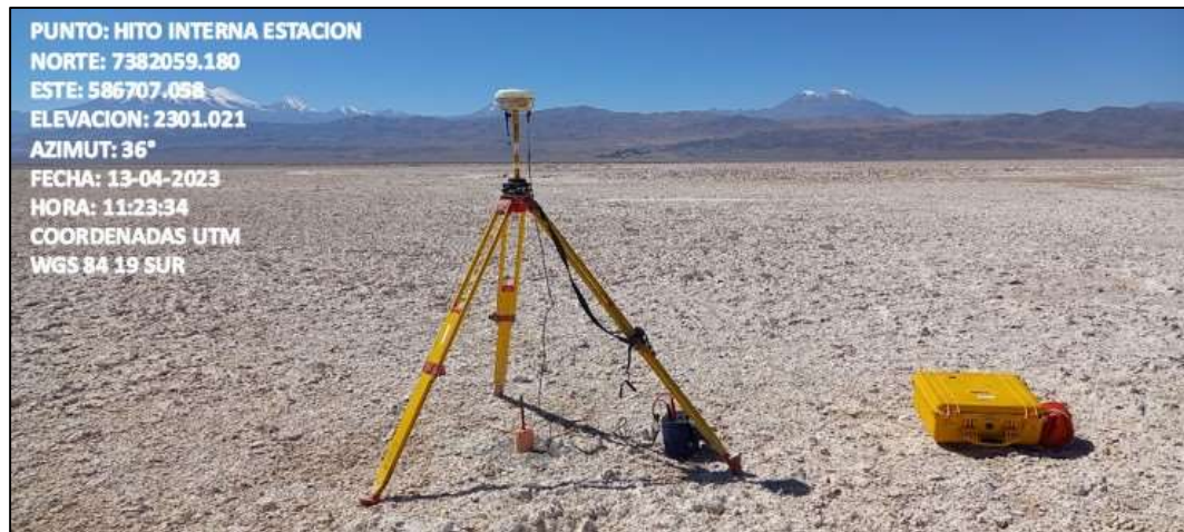
Fotografía N°16. Hito Interna Estación con equipo GPS base instalado.
