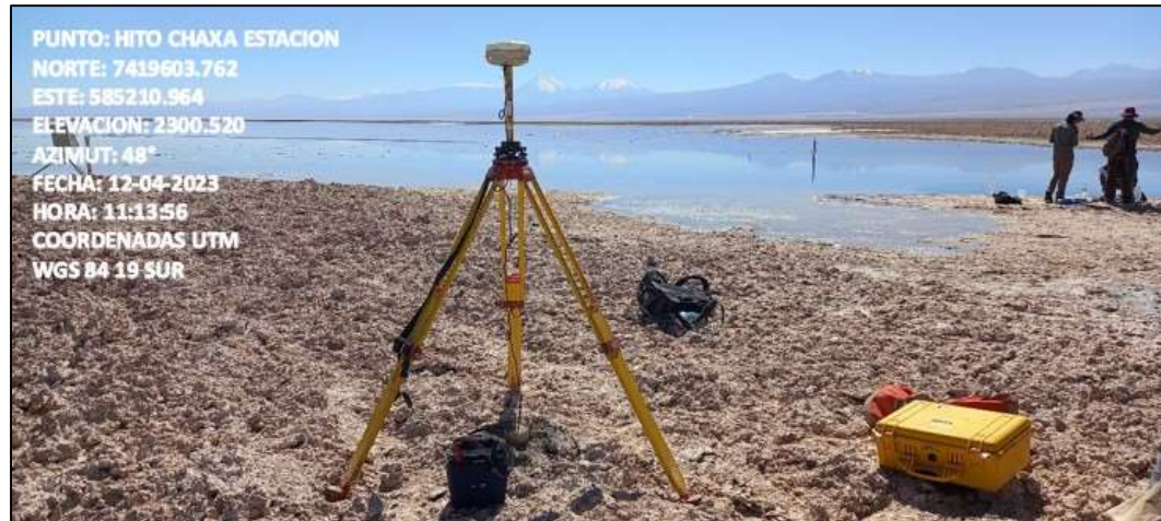
Fotografía N°10. Hito Chaxa Estación con equipo GPS base instalado.
