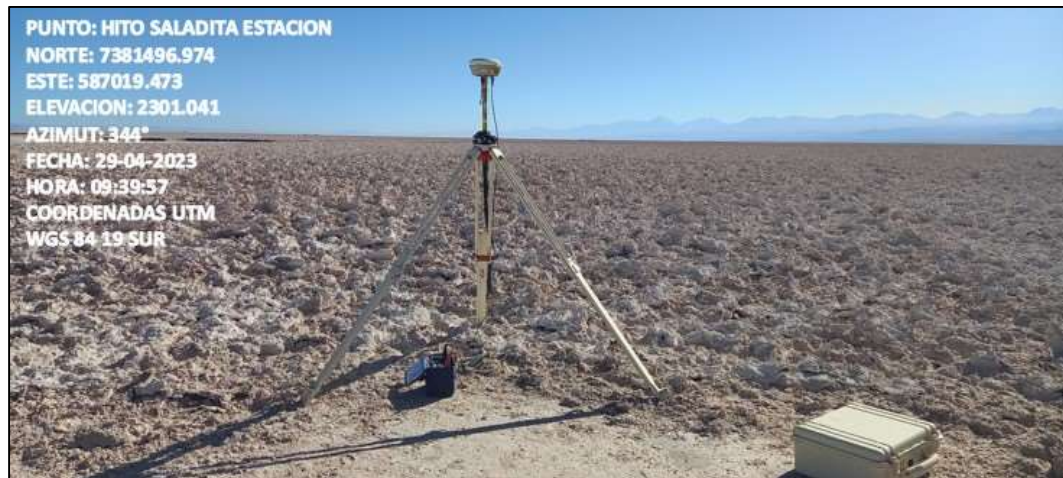
Fotografía N°19. Hito Saladita Estación con equipo GPS base instalado.
