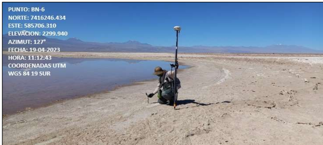
Fotografía N°6. Medición angular desde estaca BN-6 al borde de laguna Barros Negros. Fuente ATyGeo, abril 2023.
