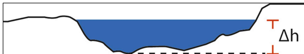
Figura N°5: Medición de espesor de columna de agua.
