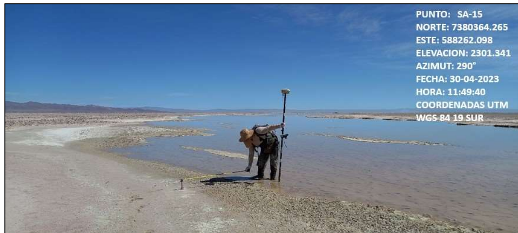
Fotografía N°7. Medición de distancia desde estaca SA-15 al borde de laguna Salada. Fuente ATyGeo, abril 2023.
