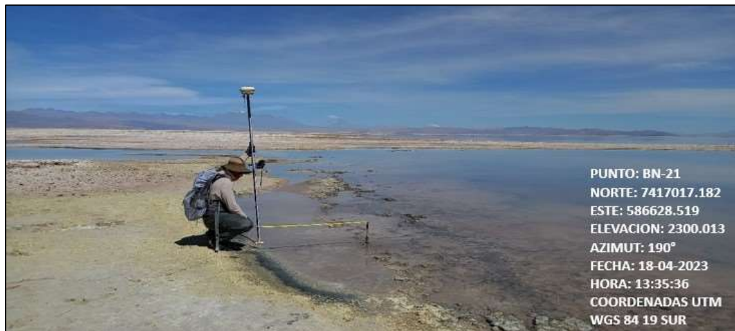
Fotografía N°5. Medición de distancia desde estaca BN-21 al borde de laguna Barros Negros. Fuente ATyGeo, abril 2023.
