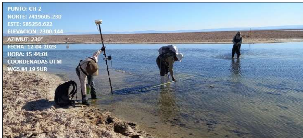
Fotografía N°3. Medición de distancia desde estaca CH-2 al borde de laguna Chaxa. Fuente ATyGeo, abril 2023.
