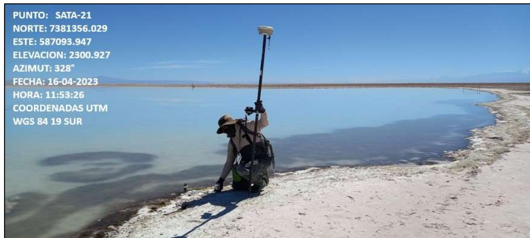
Fotografía N°9. Medición de distancia desde estaca SATA-21 al borde de laguna Saladita. Fuente ATyGeo, abril 2023.
