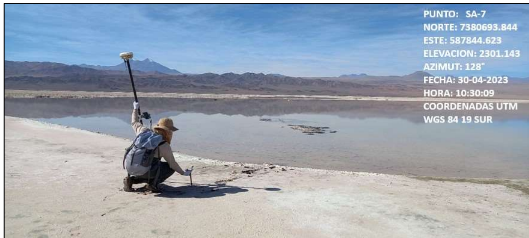
Fotografía N°8. Medición angular desde estaca SA-7 al borde de laguna Salada. Fuente ATyGeo, abril 2023.
