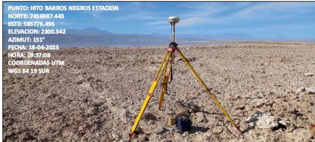
Fotografía N°13. Hito Barros Negros Estación con equipo GPS base instalado. Fuente ATyGeo, abril 2023.
