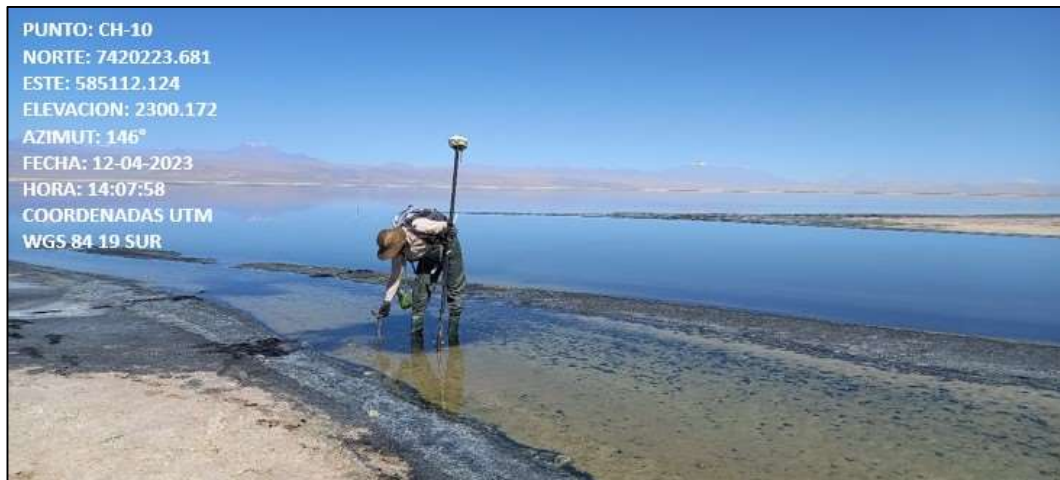
Fotografía N°4. Medición angular desde estaca CH-10 al borde de laguna Chaxa. Fuente ATyGeo, abril 2023.
