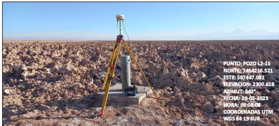
Fotografía N°1. Pozo L2-15 con equipo GPS base instalado.
