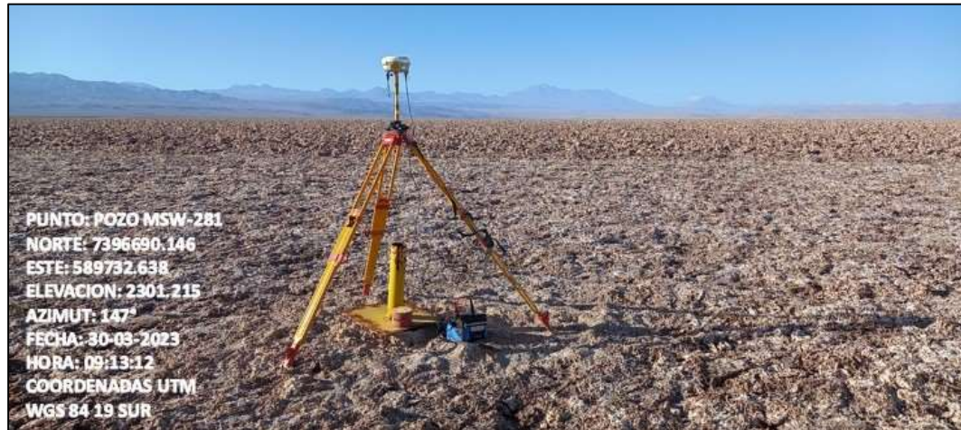
Fotografía N°4. Pozo MSW-281 con equipo GPS base instalado.
