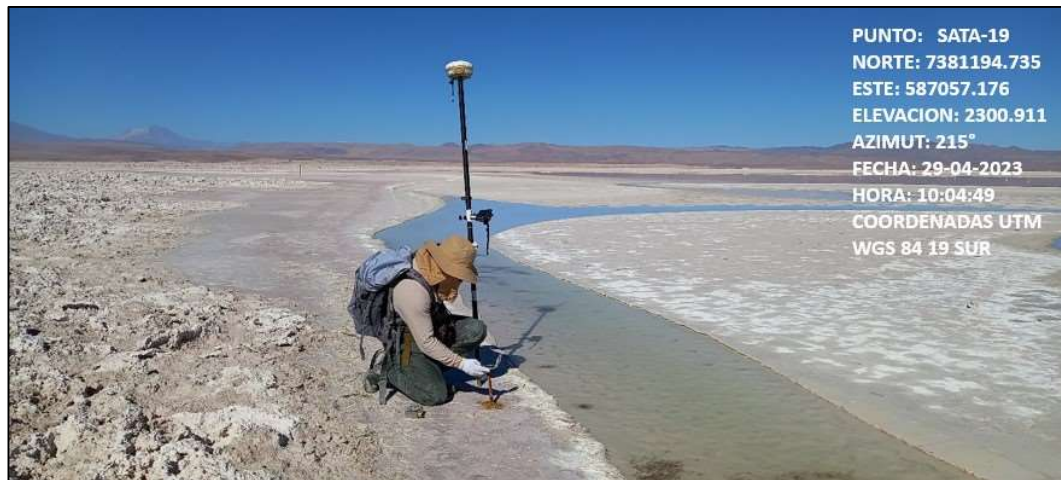
Fotografía N°10. Medición angular desde estaca SATA-19 al borde de laguna Saladita. Fuente ATyGeo, abril 2023.
