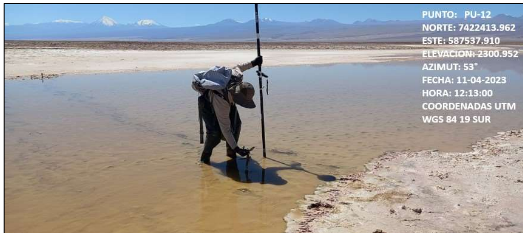
Fotografía N°2. Medición angular desde estaca PU-12 al borde de laguna Puilar. Fuente ATyGeo, abril 2023.
