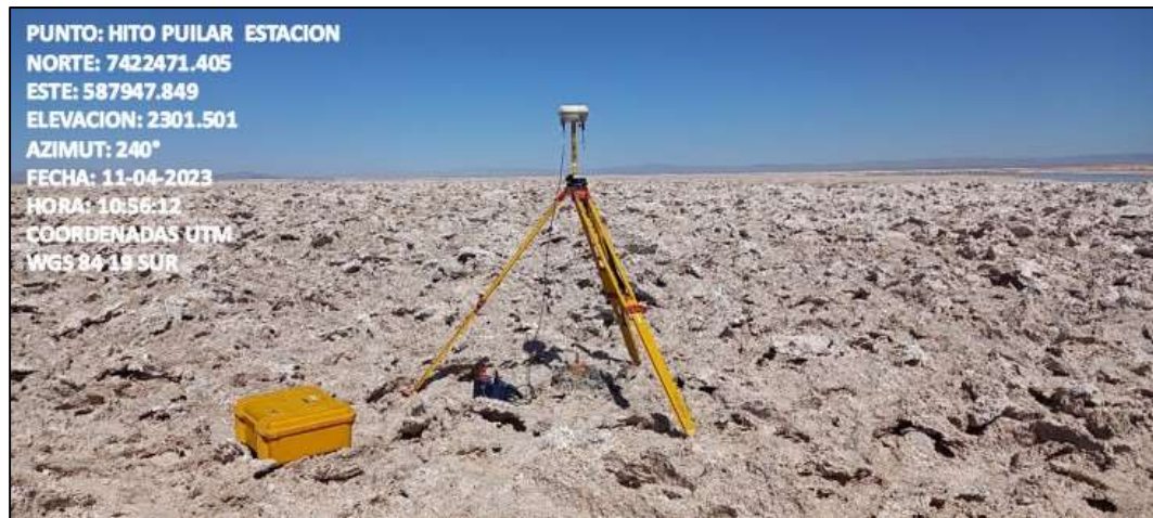
Fotografía N°7. Hito Puilar Estación con equipo GPS base instalado.
