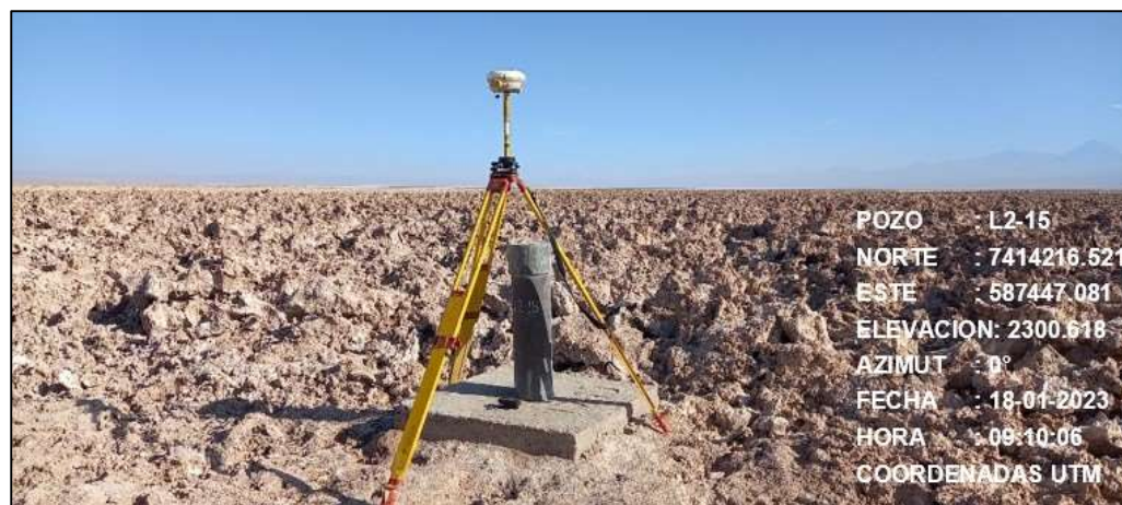
Fotografía N°1. Pozo L2-15 con equipo GPS base instalado.
