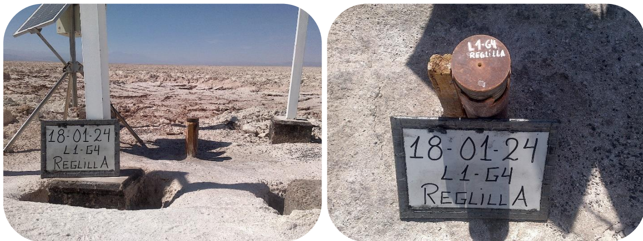
Figura 4: Fotografías del punto L1-G4 Reglilla durante el verano de 2024. Izquierda: Reglilla original, con excavación en la base para hacer el seguimiento bajo la superficie del terreno. Derecha: stick up del piezómetro que se usa actualmente
