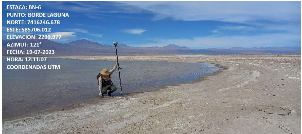
Fotografía N°5. Medición de distancia desde estaca BN-6 al borde de laguna Barros Negros. Fuente ATyGeo, julio 2023.
