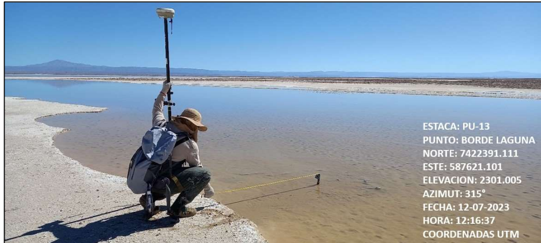
Fotografía N°1. Medición de distancia desde estaca PU-13 al borde de laguna Puilar. Fuente ATyGeo, julio 2023.
