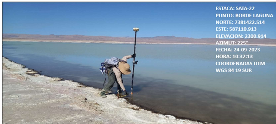
Fotografía N°2. Medición de estaca SATA-22 al borde de laguna Saladita.
