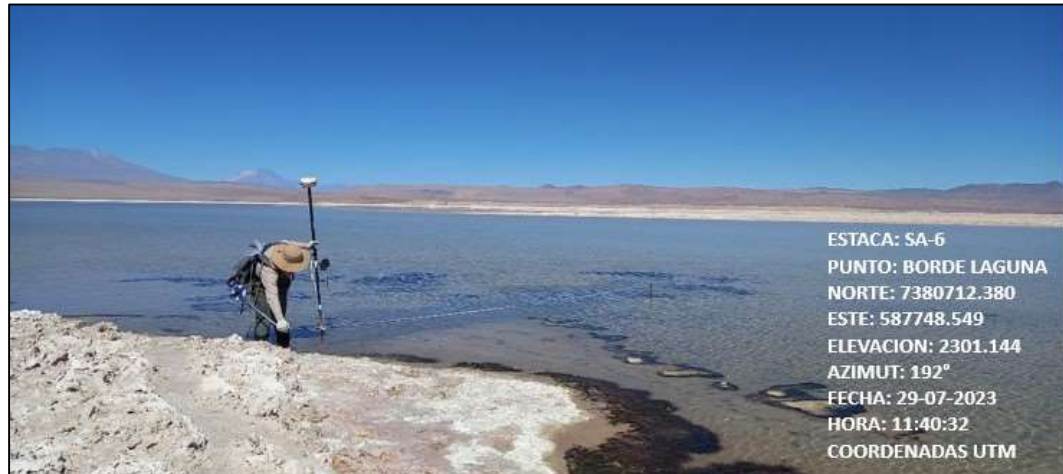
Fotografía N°7. Medición de distancia desde estaca SA-6 al borde de laguna Salada. Fuente ATyGeo, julio 2023.
