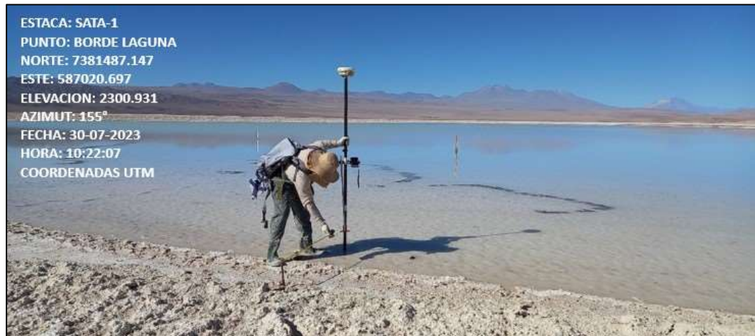
Fotografía N°9. Medición de distancia desde estaca SATA-1 al borde de laguna Saladita. Fuente ATyGeo, julio 2023.
