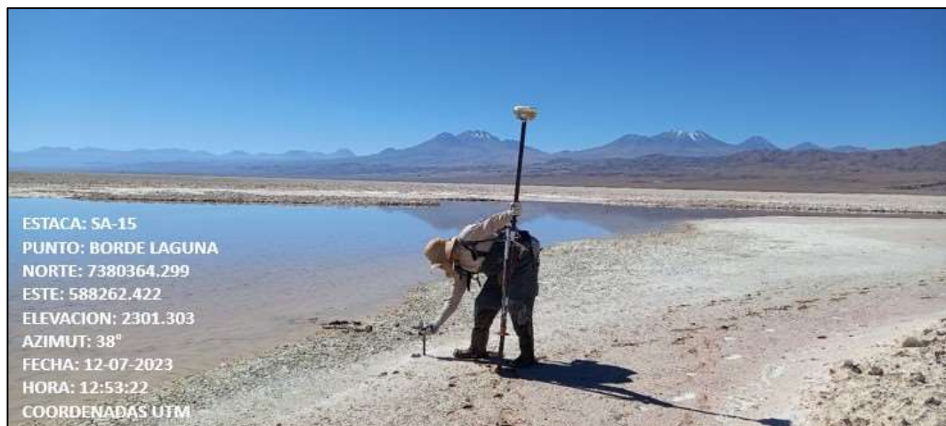
Fotografía N°8. Medición angular desde estaca SA-15 al borde de laguna Salada. Fuente ATyGeo, julio 2023.
