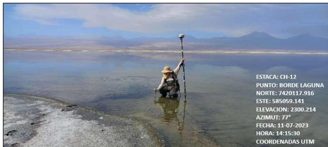
Fotografía N°4. Medición angular desde estaca CH-12 al borde de laguna Chaxa. Fuente ATyGeo, julio 2023.
