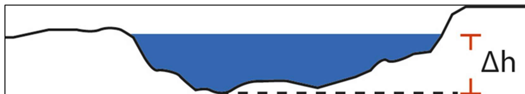
Figura N°6: Medición de espesor de columna de agua.
