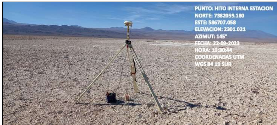
Fotografía N°1. Hito Interna Estación con equipo GPS base instalado.
