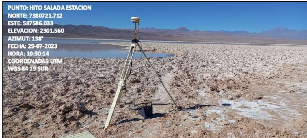
Fotografía N°17. Hito Salada Estación con equipo GPS base instalado.
