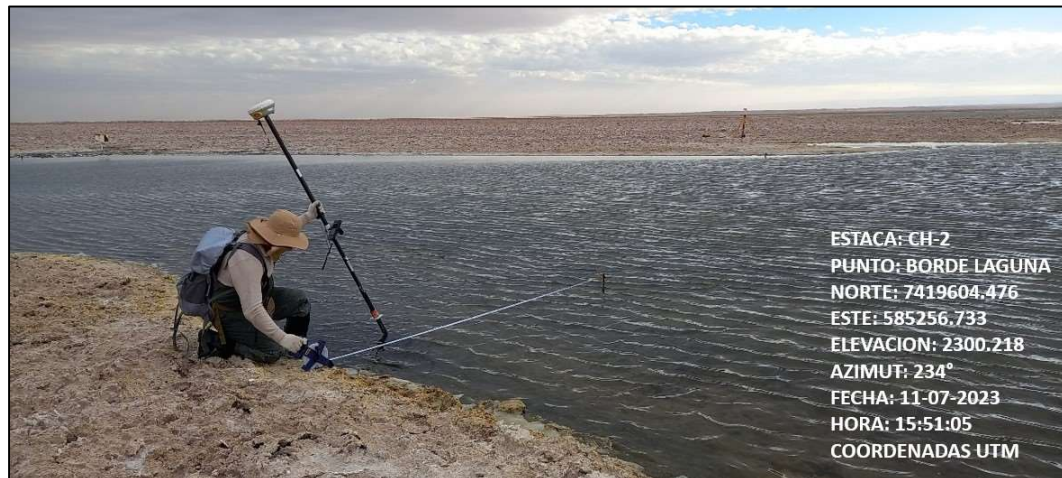
Fotografía N°3. Medición de distancia desde estaca CH-2 al borde de laguna Chaxa. Fuente ATyGeo, julio 2023.
