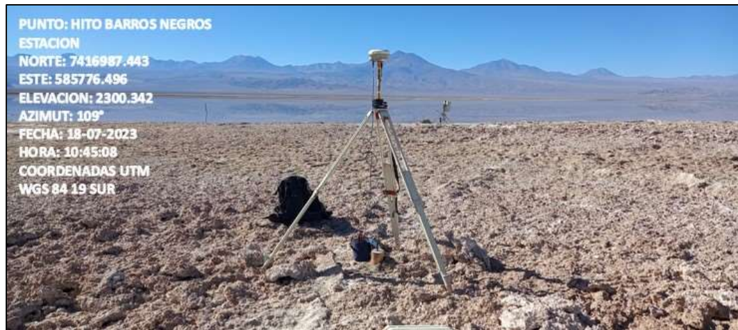
Fotografía N°11. Hito Barros Negros Estación con equipo GPS base instalado. Fuente ATyGeo, julio 2023.
