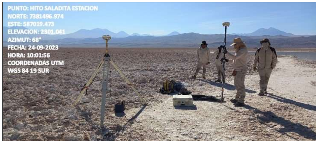
Fotografía N°4. Hito Saladita Estación con equipo GPS base instalado.
