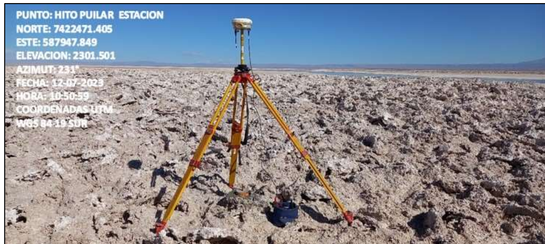
Fotografía N°8. Hito Puilar Estación con equipo GPS base instalado.
