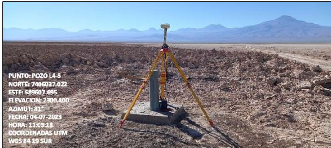
Fotografía N°2. Pozo L4-5 con equipo GPS base instalado.
