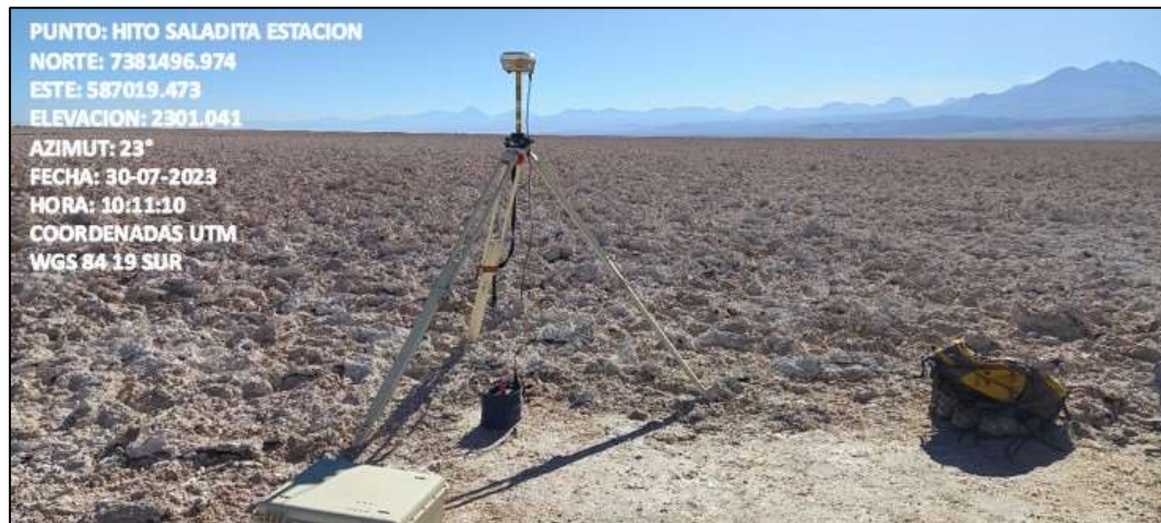
Fotografía N°20. Hito Saladita Estación con equipo GPS base instalado.
