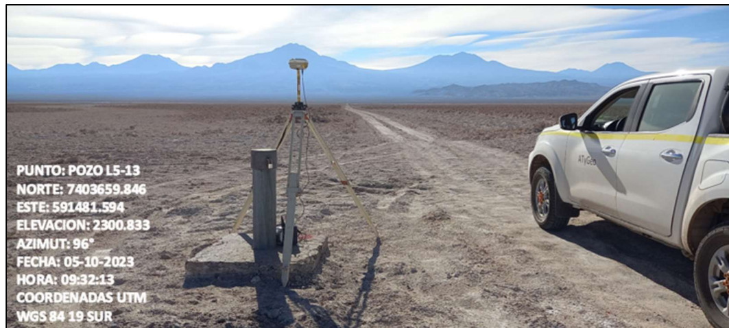
Fotografía N°8. Pozo L5-13 con equipo GPS base instalado.
