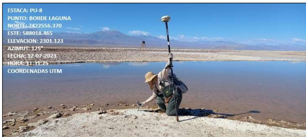
Fotografía N°2. Medición angular desde estaca PU-8 al borde de laguna Puilar. Fuente ATyGeo, julio 2023.
