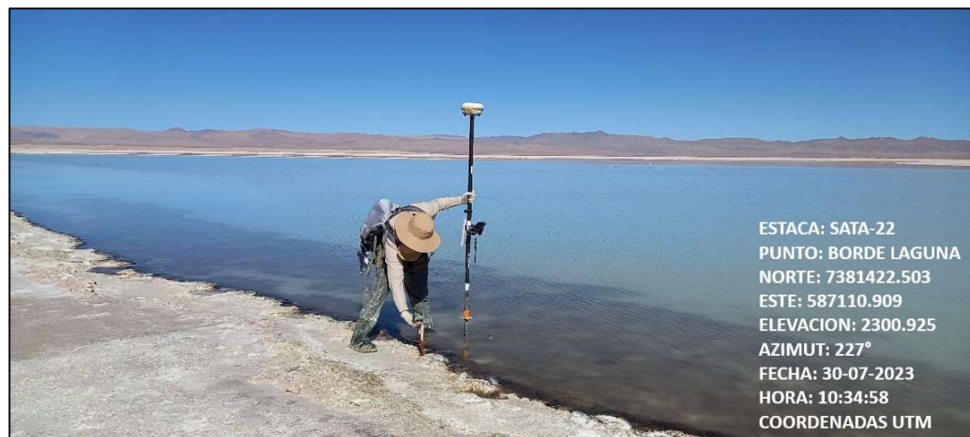
Fotografía N°10. Medición angular desde estaca SATA-22 al borde de laguna Saladita. Fuente ATyGeo, julio 2023.
