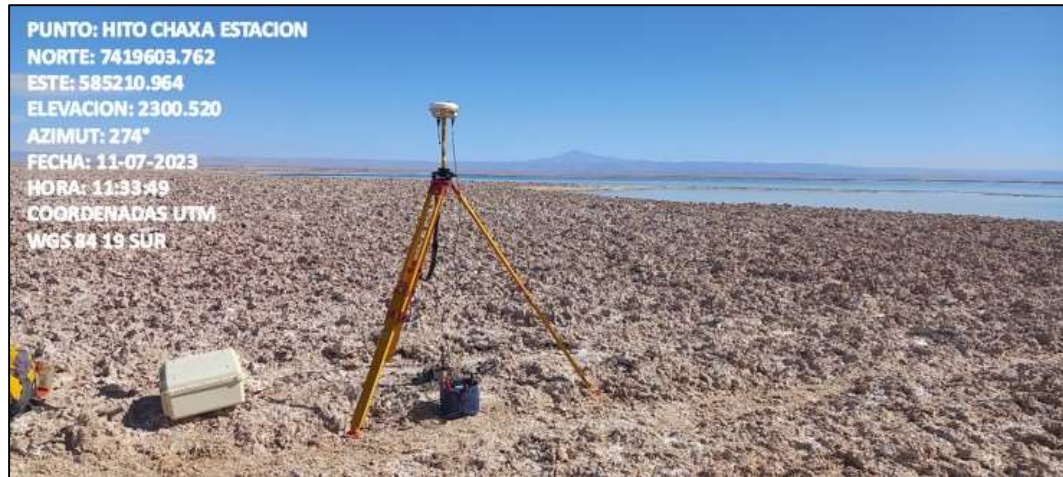
Fotografía N°5. Hito Chaxa Estación con equipo GPS base instalado.
