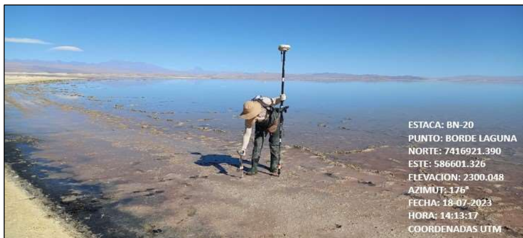
Fotografía N°6. Medición angular desde estaca BN-20 al borde de laguna Barros Negros. Fuente ATyGeo, julio 2023.
