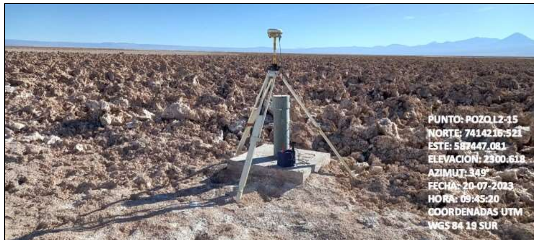
Fotografía N°14. Pozo L2-15 con equipo GPS base instalado.
