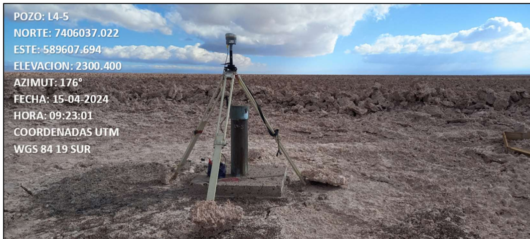
Fotografía N°6. Pozo L4-5 con el equipo GNSS base instalado.
