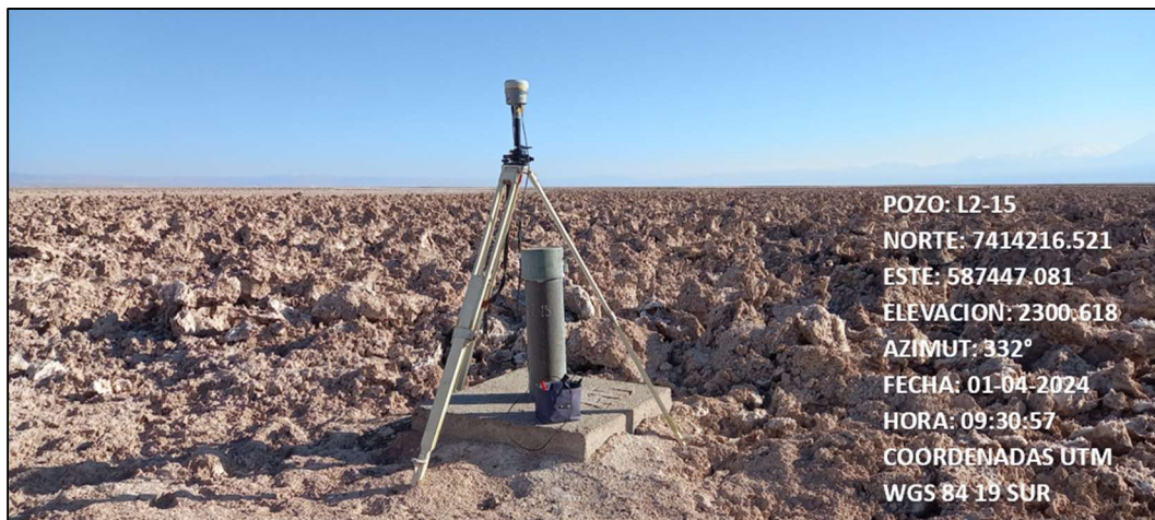
Fotografía N°1. Pozo L2-15 con el equipo GNSS base instalado.
