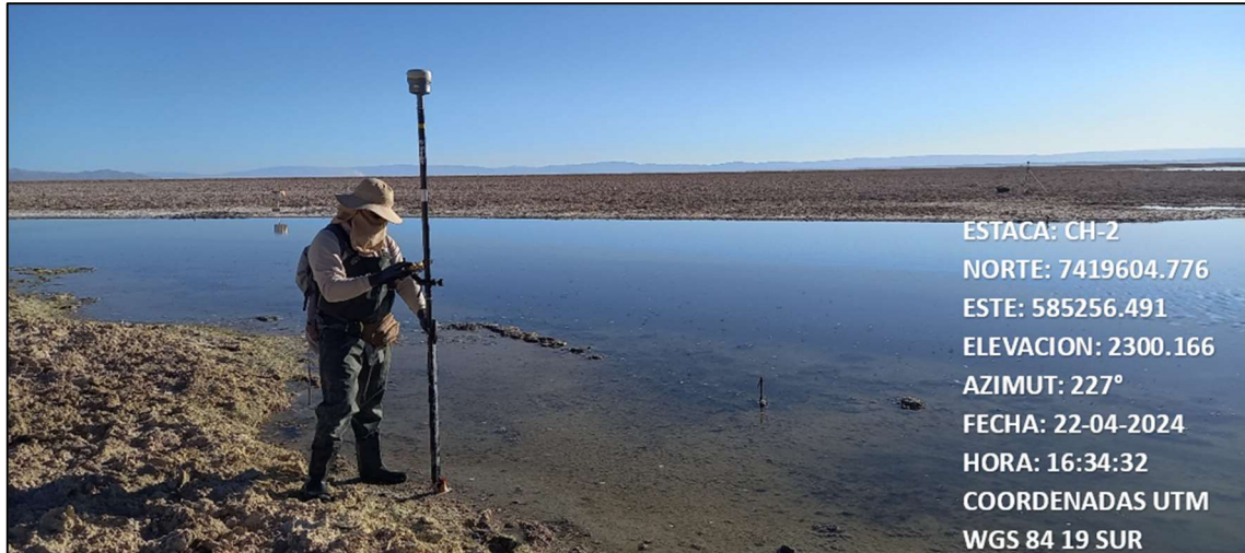
Fotografía N°1. Medición de borde más próximos a la estaca CH-2 de laguna Chaxa. Las coordenadas indicadas en la foto corresponden al punto del borde lagunar medido. Fuente ATyGeo, abril 2024.
