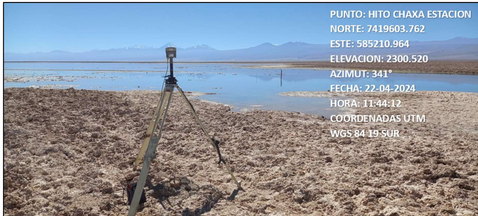
Fotografía N°13. Hito Chaxa Estación con equipo GPS base instalado.
