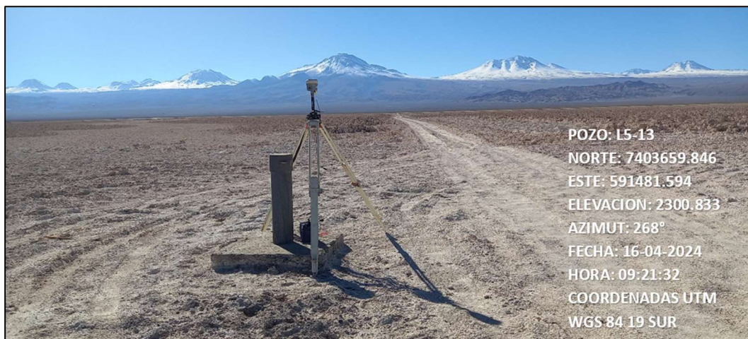
Fotografía N°7. Pozo L5-13 con el equipo GNSS base instalado.
