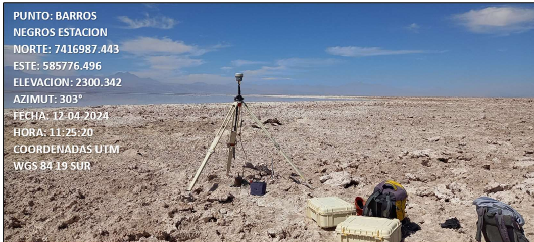
Fotografía N°10. Hito Barros Negros Estación con equipo GPS base instalado. Fuente ATyGeo, abril 2024.
