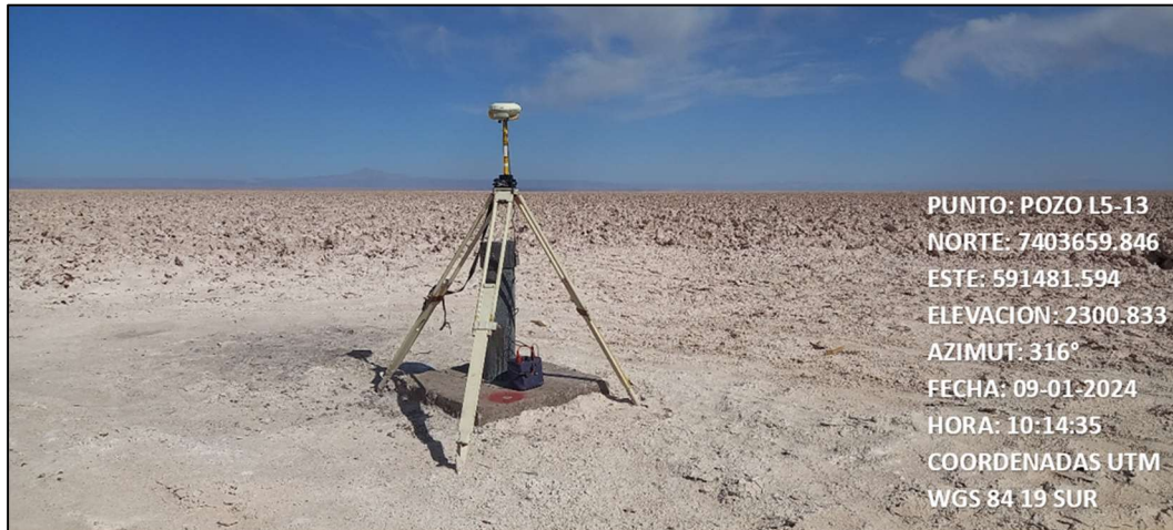
Fotografía N°2. Pozo L5-13 con el equipo GNSS base instalado.
