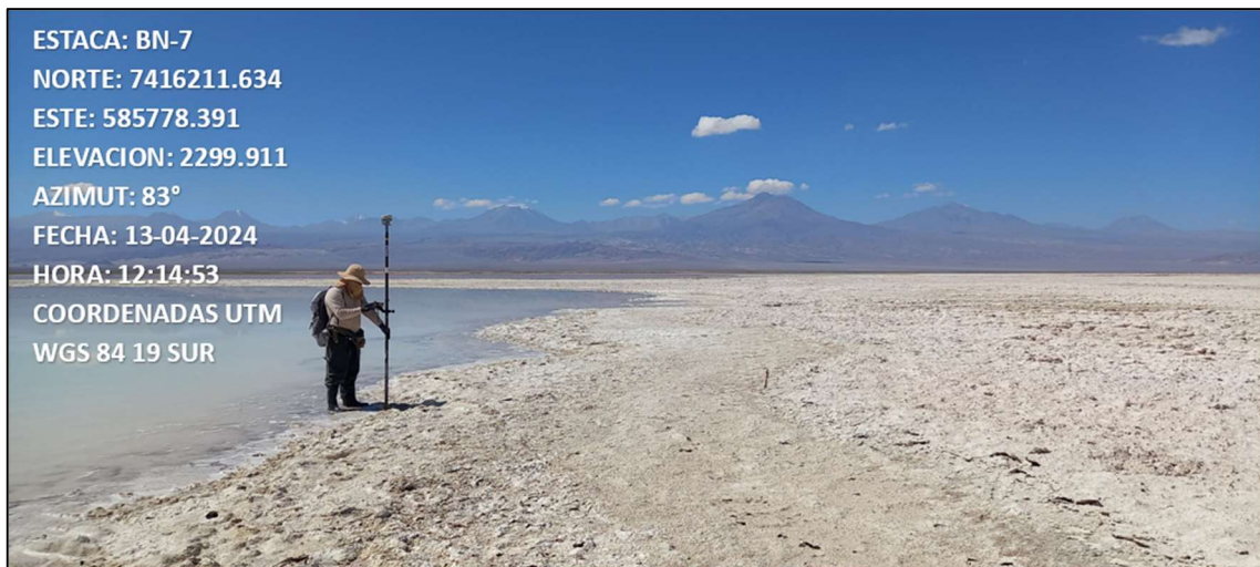
Fotografía N°4. Medición de borde más próximos a la estaca BN-7 de laguna Barros Negros. Las coordenadas indicadas en la foto corresponden al punto del borde lagunar medido. Fuente ATyGeo, abril 2024.
