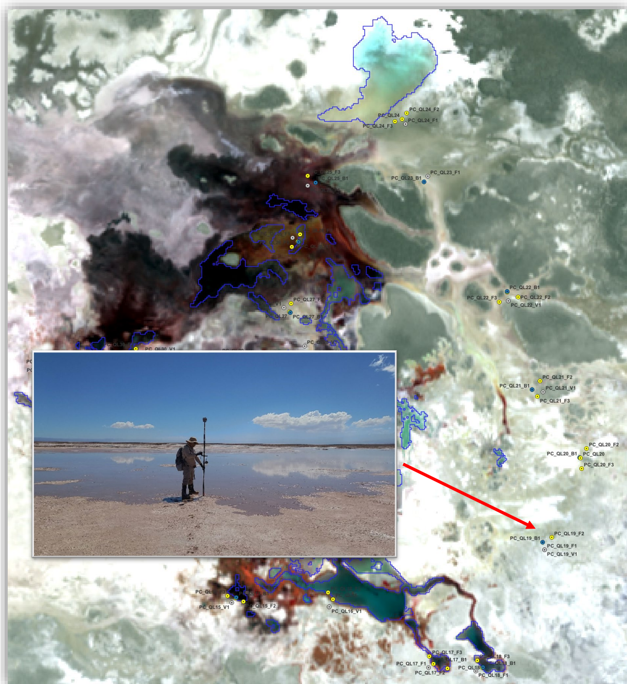
Figura 11: Puntos de control de borde de agua que no se evidencian en la imagen satelital. La fotografía corresponde al punto PC_QL19 (591.753,24 E; 7.405.776,74 N), tomada el 15-04-2024 con un azimut de 346°.
