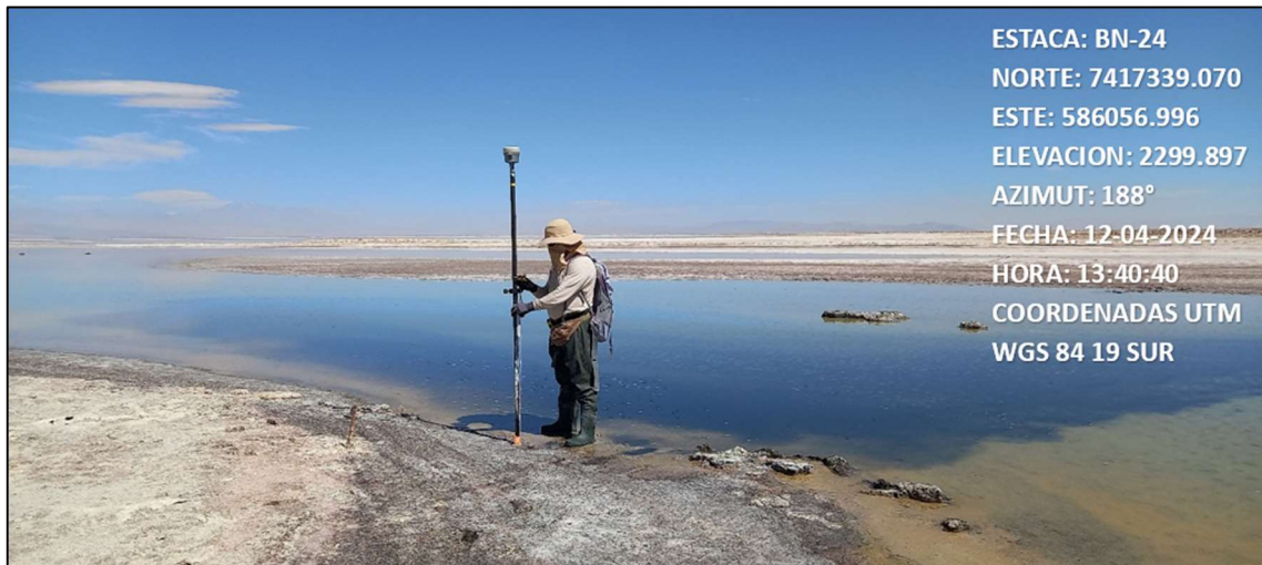
Fotografía N°3. Medición de borde más próximos a la estaca BN-24 de laguna Barros Negros. Las coordenadas indicadas en la foto corresponden al punto del borde lagunar medido. Fuente ATyGeo, abril 2024.
