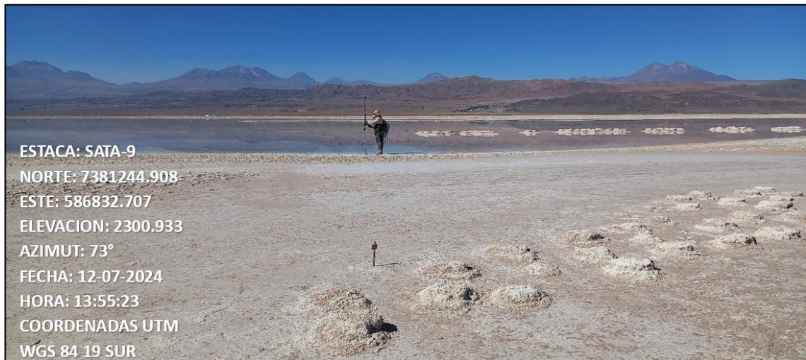
Fotografía N°1. Medición del borde más próximo a la estaca SATA-9 de laguna Saladita. Las coordenadas indicadas en la foto corresponden al punto del borde lagunar medido. Fuente ATyGeo, julio 2024.
