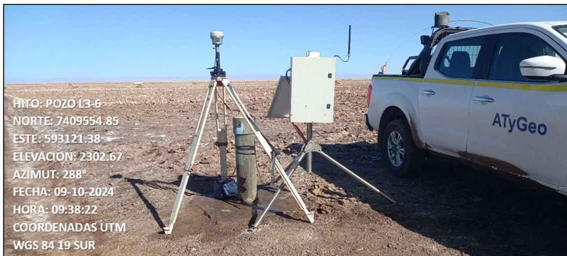
Fotografía N°10. Pozo L3-6 con el equipo GNSS base instalado.
