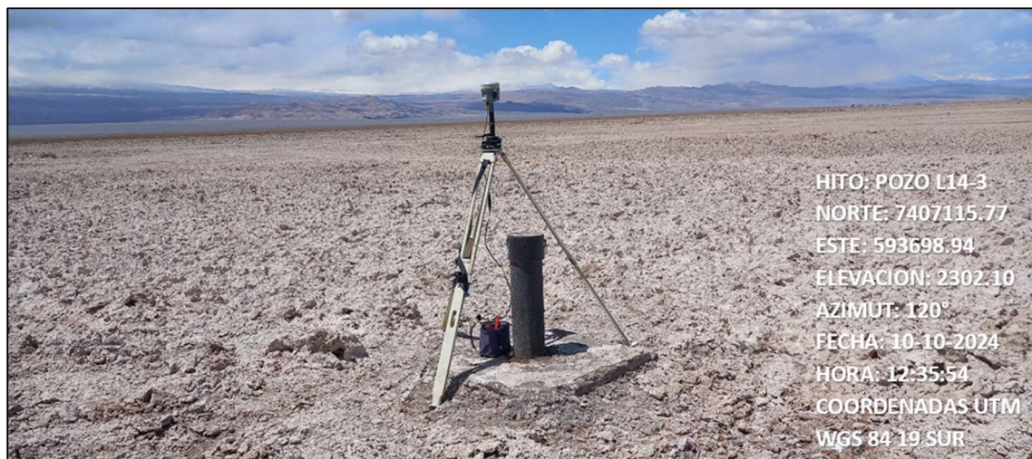
Fotografía N°12. Pozo L14-3 con el equipo GNSS base instalado.
