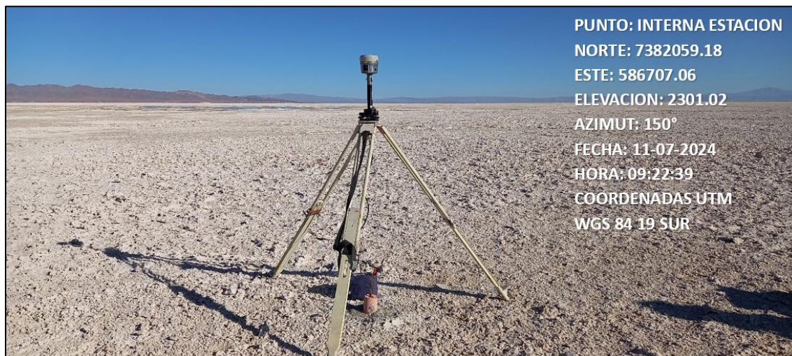
Fotografía N°9. Hito Interna Estación con equipo GPS base instalado.
