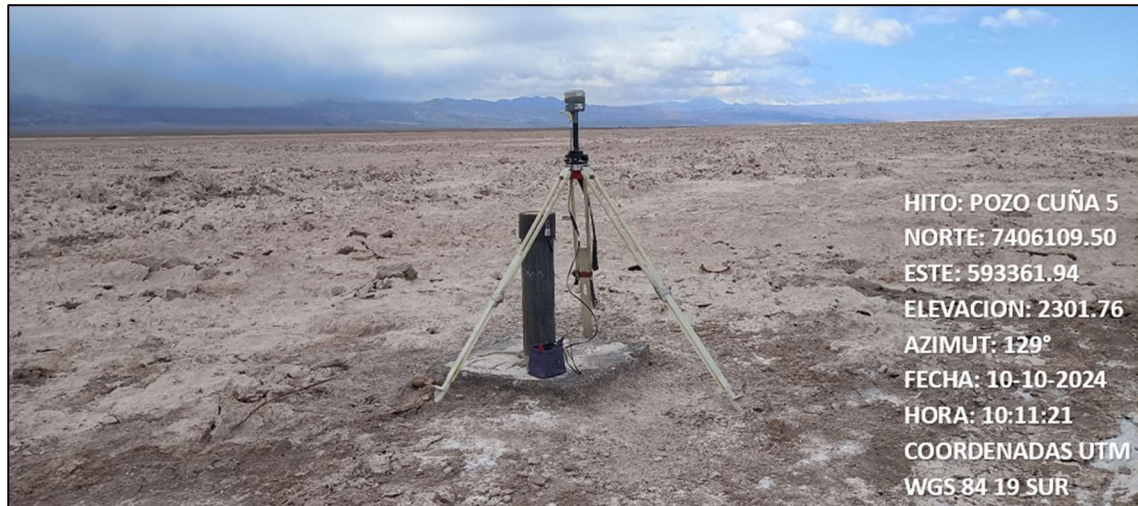
Fotografía N°11. Pozo CUÑA 5 con el equipo GNSS base instalado.
