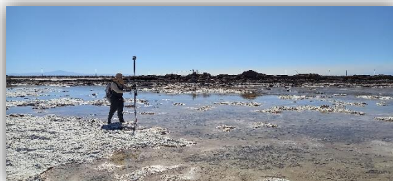
Figura 22: Puntos de control de borde lagunar en Desborde Laguna Interna. Se puede apreciar que los puntos de control IN19, IN20 e IN21 marcan bordes de agua que en la imagen no se aprecian. Las fotos inferiores corresponden a vistas a los puntos IN19 e IN20 donde se aprecia el cuerpo de agua.
