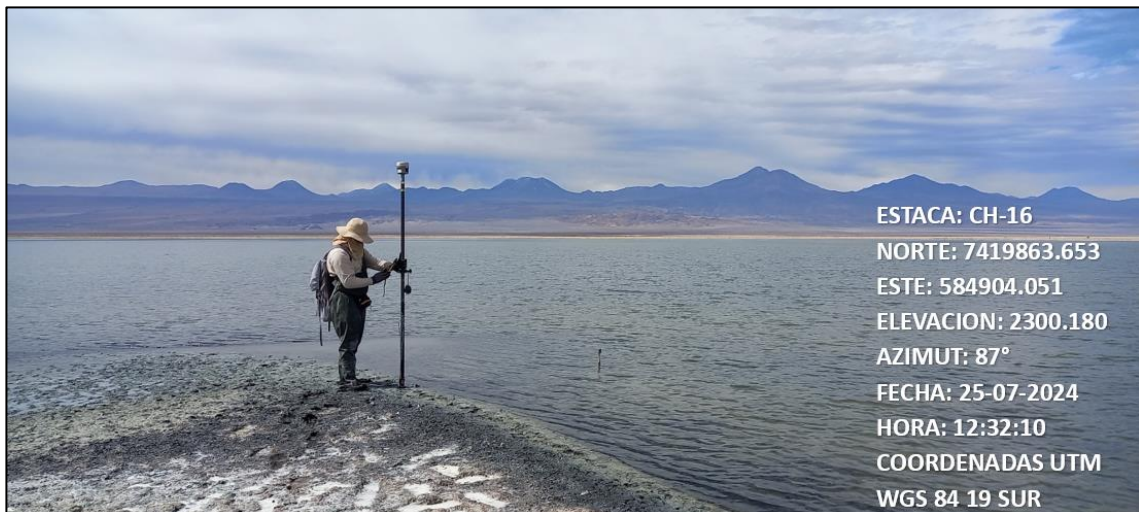
Fotografía N°4. Medición del borde más próximo a la estaca CH-16 de laguna Chaxa. Las coordenadas indicadas en la foto corresponden al punto del borde lagunar medido. Fuente ATyGeo, julio 2024.
