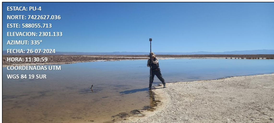
Fotografía N°5. Medición del borde más próximo a la estaca PU-4 de laguna Puilar. Las coordenadas indicadas en la foto corresponden al punto del borde lagunar medido. Fuente ATyGeo, julio 2024.
