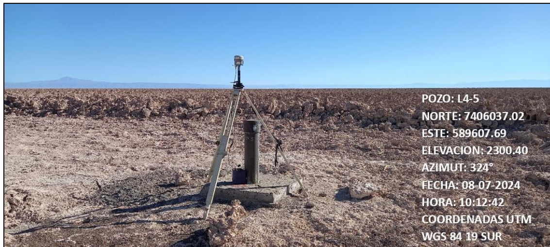
Fotografía N°5. Pozo L4-5 con el equipo GNSS base instalado.
