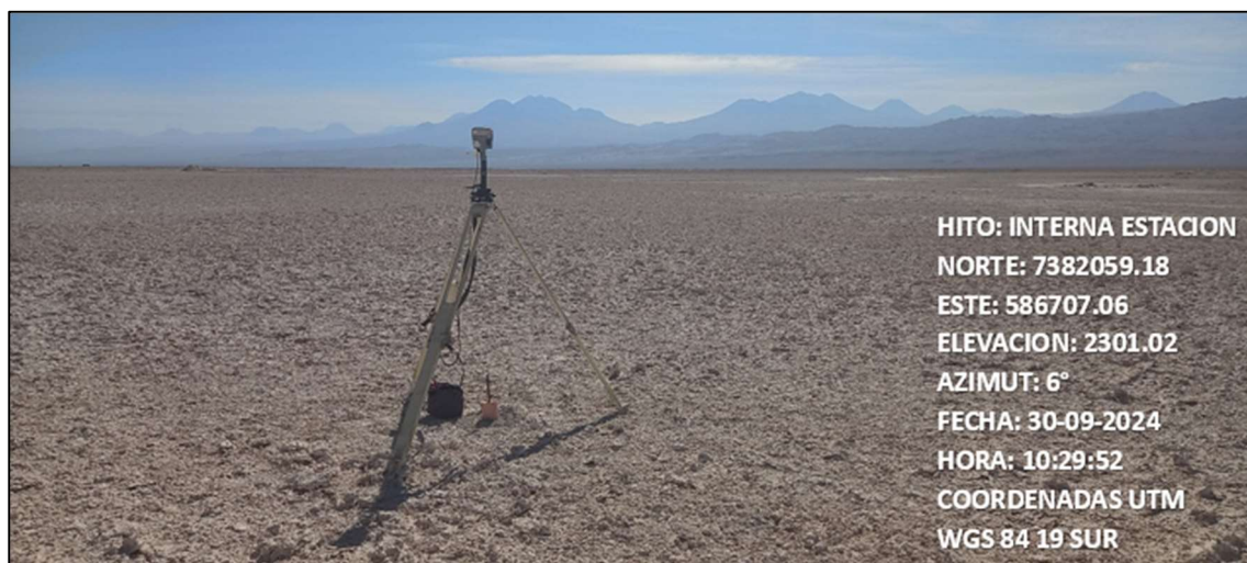
Fotografía N°1. Hito Interna Estación con equipo GNSS base instalado.
