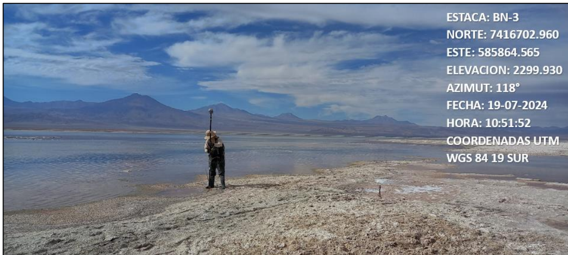
Fotografía N°3. Medición del borde más próximo a la estaca BN-3 de laguna Barros Negros. Las coordenadas indicadas en la foto corresponden al punto del borde lagunar medido. Fuente ATyGeo, julio 2024.
