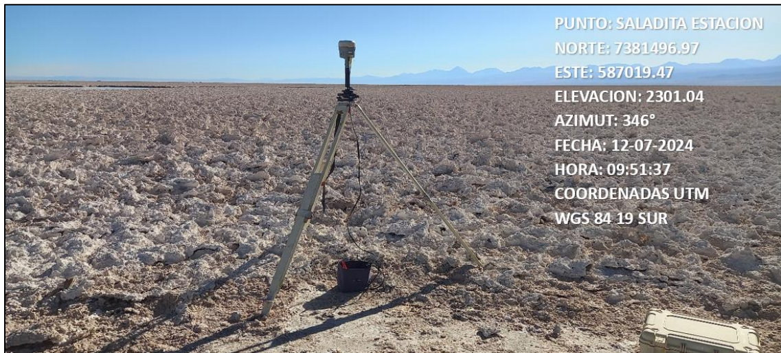
Fotografía N°12. Hito Saladita Estación con equipo GPS base instalado.
