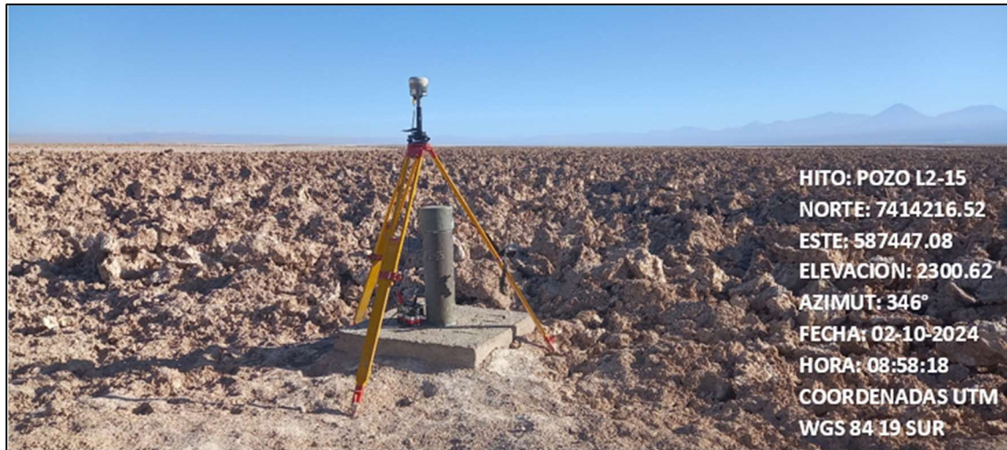
Fotografía N°5. Pozo L2-15 con el equipo GNSS base instalado.
