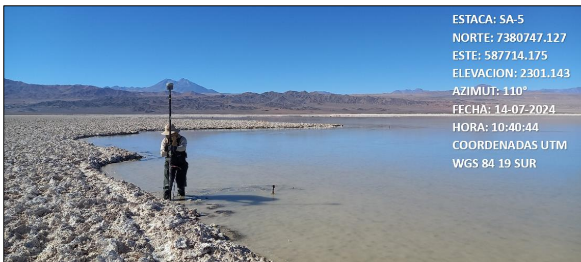
Fotografía N°2. Medición del borde más próximo a la estaca SA-5 de laguna Salada. Las coordenadas indicadas en la foto corresponden al punto del borde lagunar medido. Fuente ATyGeo, julio 2024.
