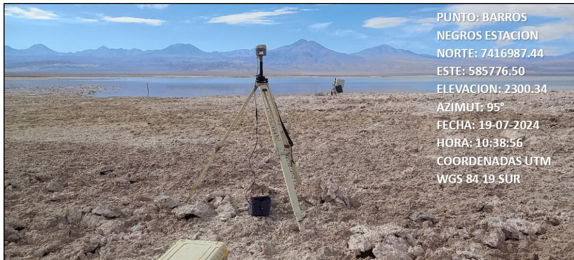
Fotografía N°18. Hito Barros Negros Estación con equipo GPS base instalado. Fuente ATyGeo, julio 2024.
