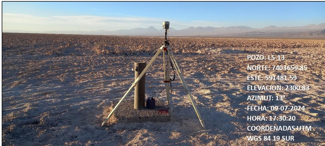
Fotografía N°6. Pozo L5-13 con el equipo GNSS base instalado.
