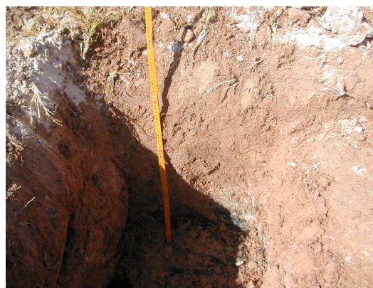
Perfil de la Calicata
