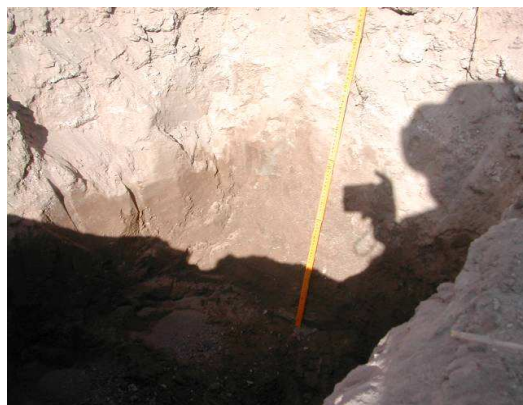
Perfil de la Calicata
