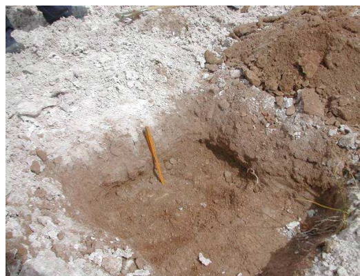
Perfil de la Calicata
