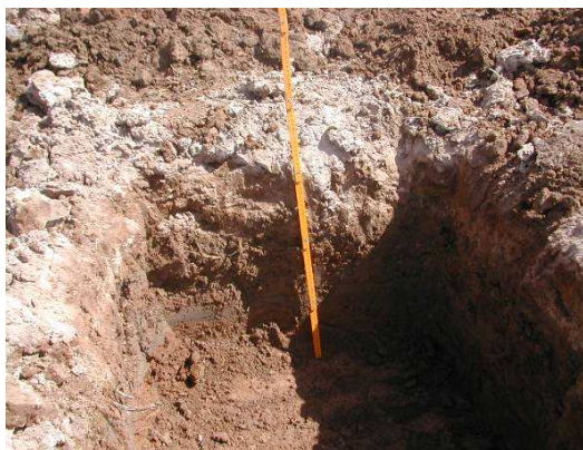
Perfil de la Calicata
