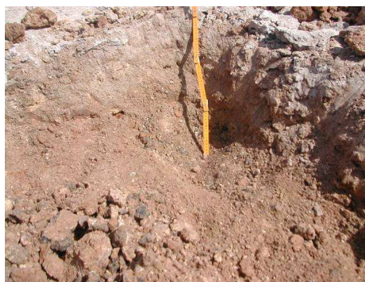
Perfil de la Calicata
