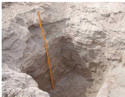
Perfil de la Calicata
