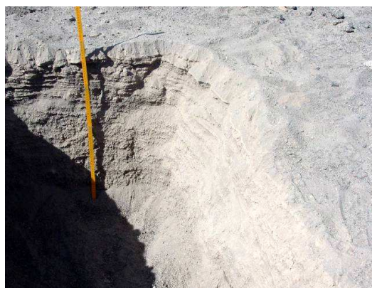
Perfil de la Calicata
