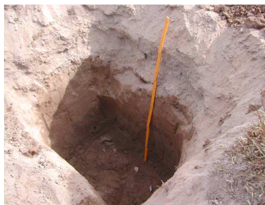
Perfil de la Calicata
