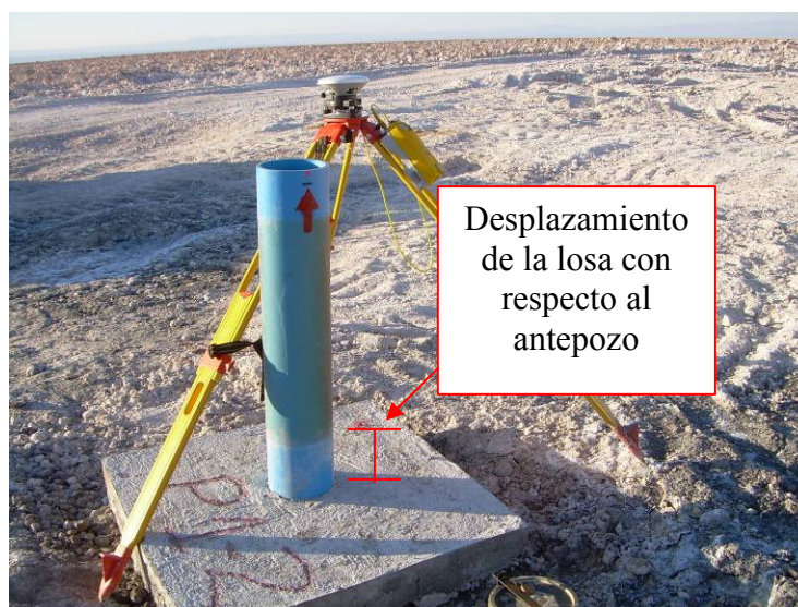
Foto 4-8. Desplazamiento de la losa con respecto al antepozo del Pozo P1-2
