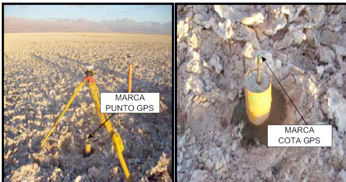
Fotografía 5.4-2. Condiciones originales del monolito topográfico del pozo L11-2.
