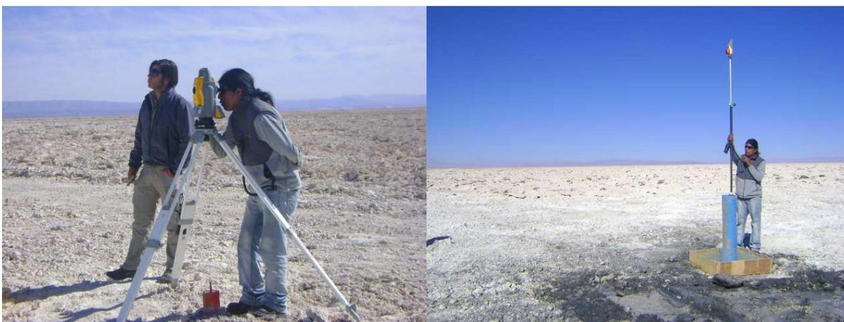
**Figura 4.14. Fotografía de medición de coordenadas y cotas topográficas de pozos de remplazo.**
