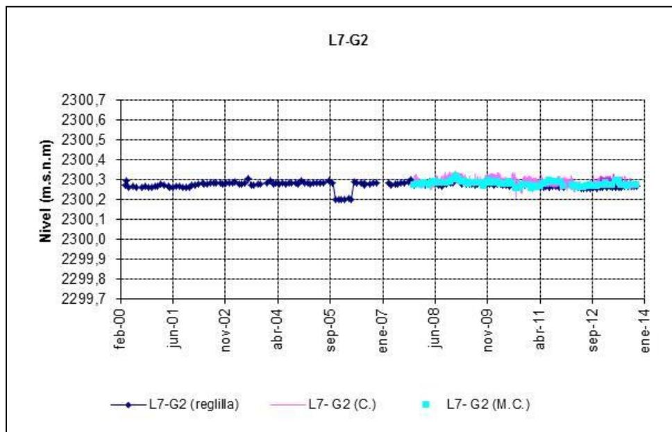
**Figura 4-64: Nivel mensual observado en la reglilla L7-G2 desde el 13 de mayo de 2007, fecha de inicio de medición de pozos del PC. (Línea burdeos: medición continua; línea azul: medición manual en antigua reglilla; puntos celeste: medición manual en reglilla nueva con medición continua)**
