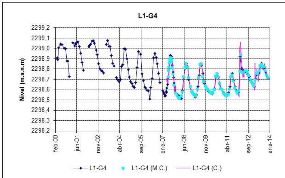
**Figura 4-61: Nivel observado en la reglilla L1-G4 desde el 13 de mayo de 2007, fecha de inicio de medición de pozos del PC. (Línea magenta: medición continua; línea azul: medición manual en antigua reglilla; puntos celestes: medición manual en reglilla nueva con medición continua)**
