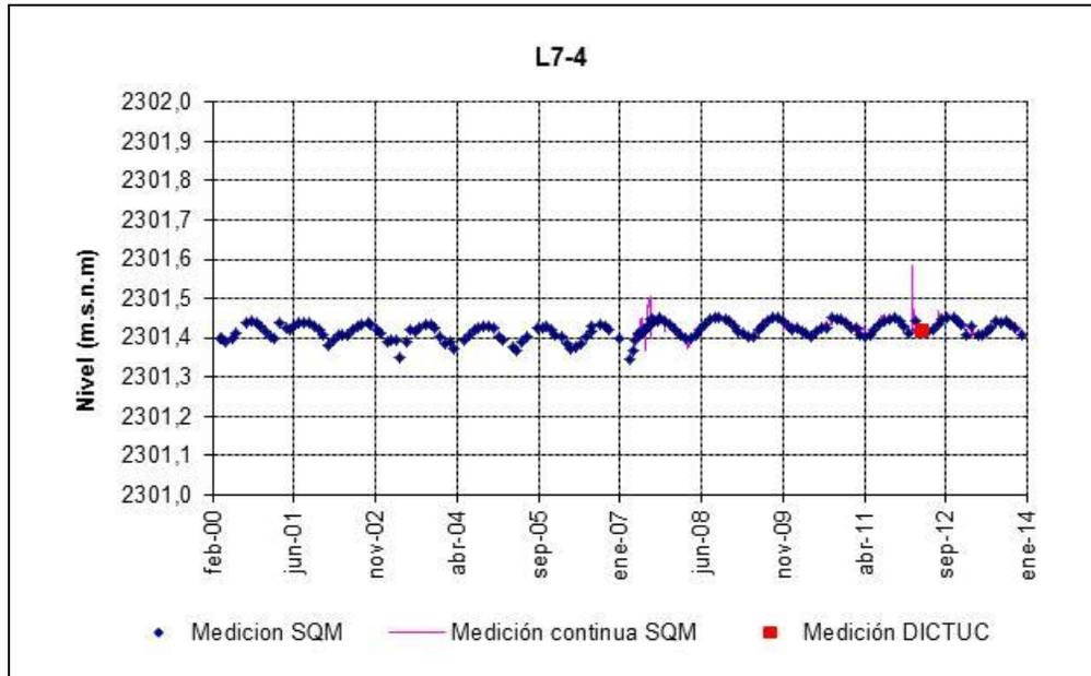
**Figura 4-52: Nivel mensual observado en el pozo L7-4 desde el 13 de mayo de 2007, fecha de inicio de medición de pozos del PC (línea magenta: medición continua, puntos azules: mediciones manuales)**
