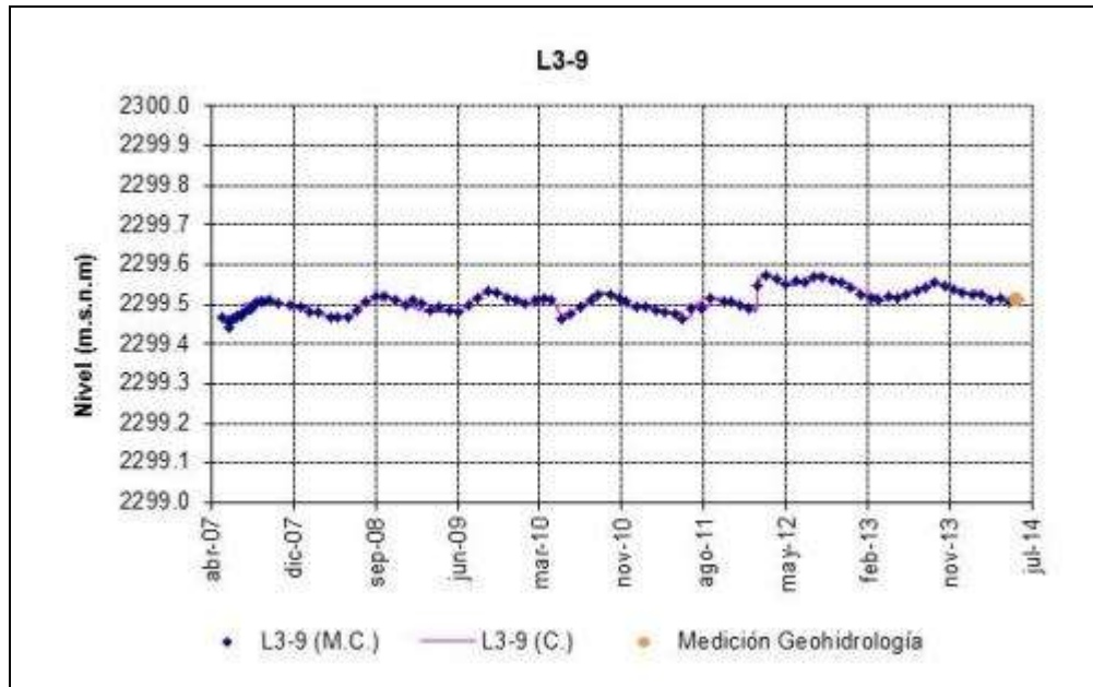
Figura 4-169: Nivel observado en el pozo L3-9 (línea magenta: medición continua, puntos azules: mediciones manuales)
