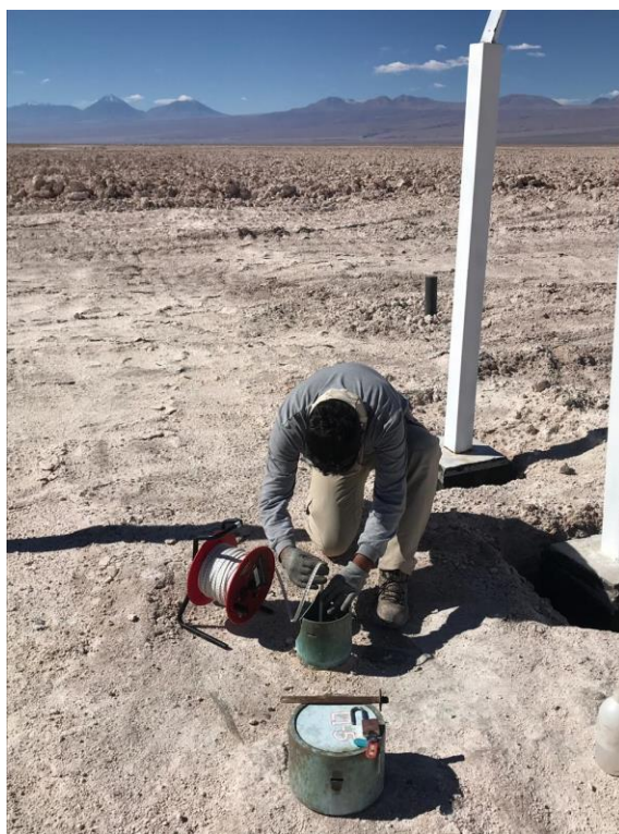
Figura 14: Medición de nivel piezométrico L1-5.
