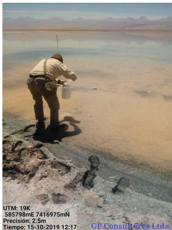
Figura A.1.1: Punto de Monitoreo BARROS NEGROS Toma de muestra desde orilla con Envase Auxiliar.
