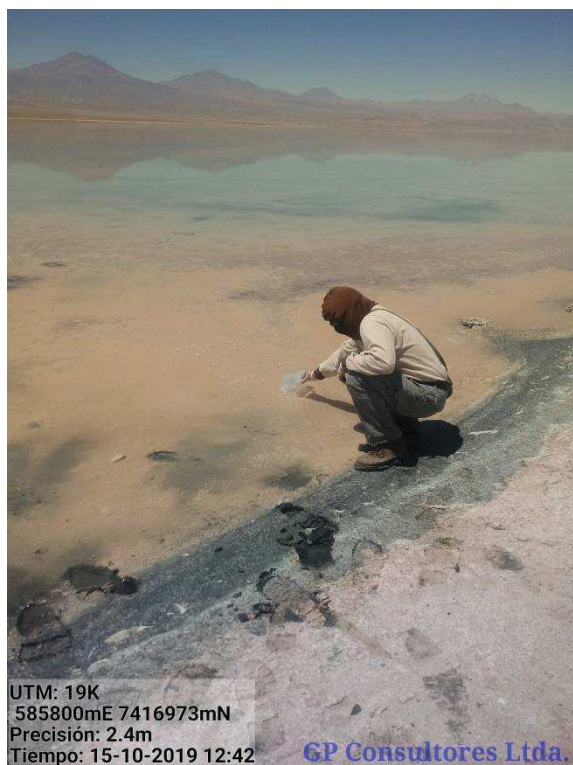
Figura A.1.1: Punto de Monitoreo BARROS NEGROS Toma de muestra desde orilla con Envase Auxiliar.
