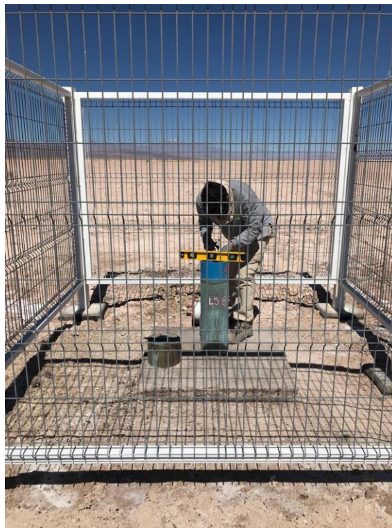
Figura 11: Medición de nivel piezométrico en pozo L5-8.
