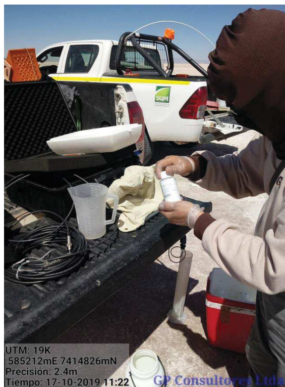
Figura A.2.2: Punto de Monitoreo L1-G4 Medición de parámetros y Llenado de Botellas.
