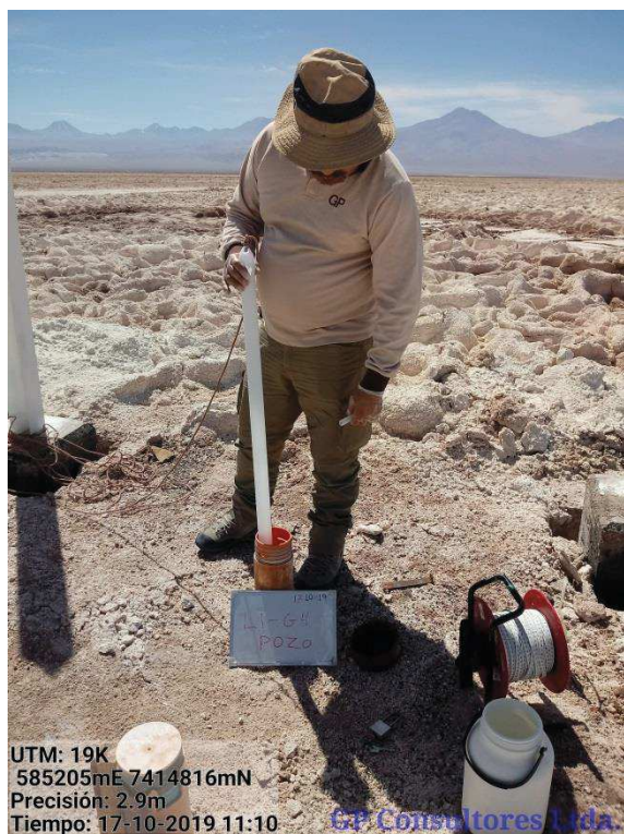
Figura A.2.1: Punto de Monitoreo L1-G4 Toma de Muestra con Bailer.
