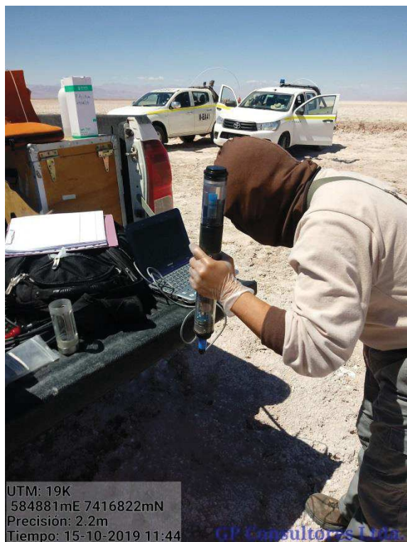
Figura A.1.2: Punto de Monitoreo BARROS NEGROS Medición de Parámetros de Terreno y llenado de botellas.
