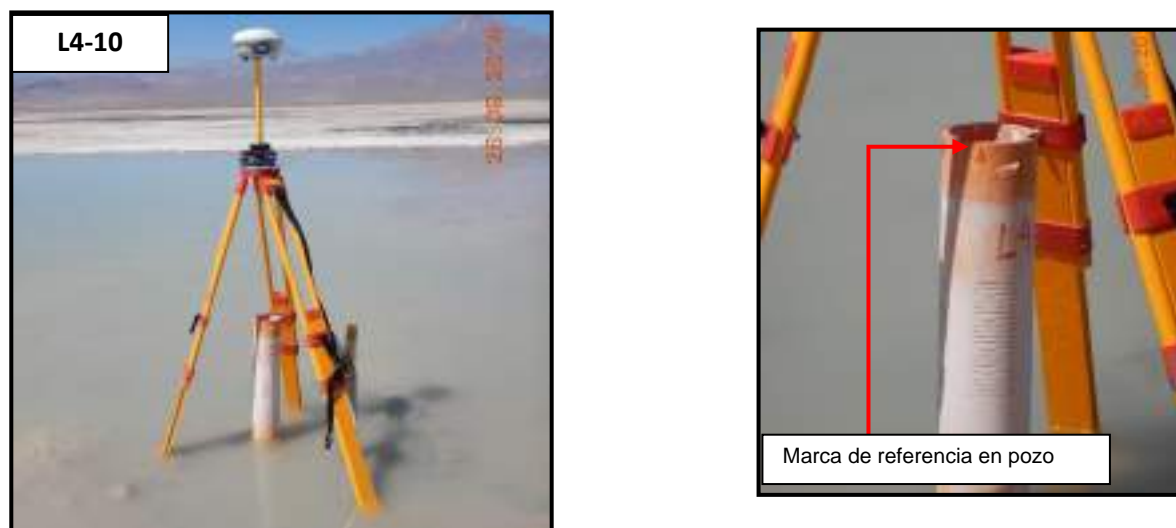
Figura 5. Pozo L4-10. Referencia en pozo. Panel izquierdo situación general del pozo en levantamiento. Panel derecho detalle de marca de la referencia Geográfica que marca la coordenada de ubicación del pozo.
