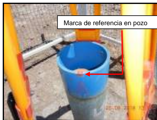
Figura 2. Pozo L4-7. Referencia en pozo. Panel izquierdo situación general del pozo en levantamiento. Panel derecho detalle de marca de la referencia Geográfica y de elevación del pozo.
