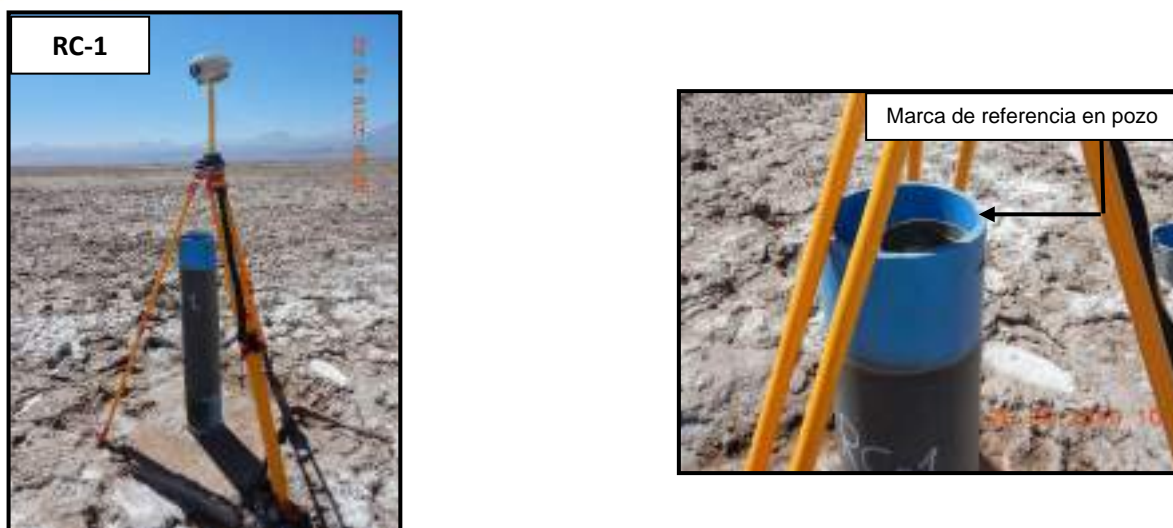
Figura 6. Pozo RC-1. Referencia en pozo. Panel izquierdo situación general del pozo en levantamiento. Panel derecho detalle de marca de la referencia Geográfica que marca la elevación de la referencia del pozo.
