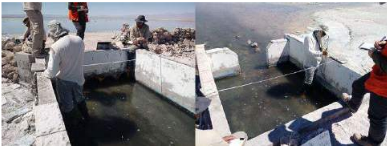
Foto 2. Medición de velocidad. SQM-GHS. Puente San Luis.
