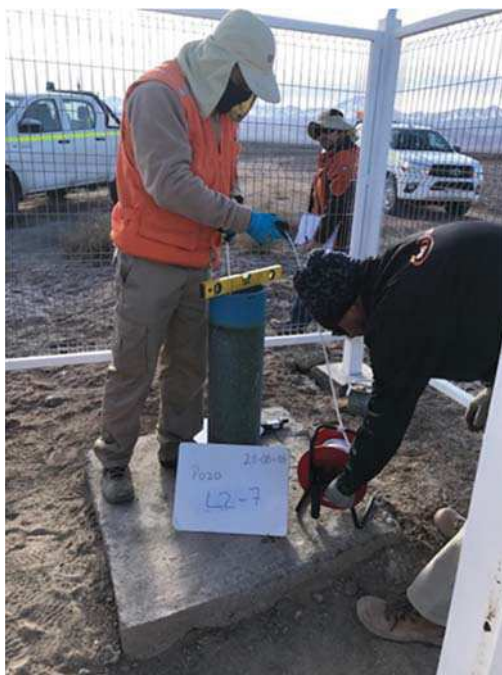
Figura 1: Medición de nivel piezométrico en Pozo L2-7 de Aguas de Quelana, Sector de Allana.
