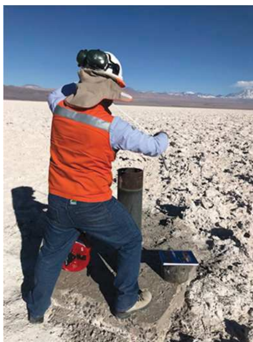
Figura 11: Medición de nivel piezométrico en Pozo L10-4 del Sector de Peine
