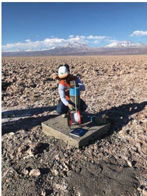
Figura 12: Medición de nivel piezométrico en Pozo L10-11 del Sector de Peine
