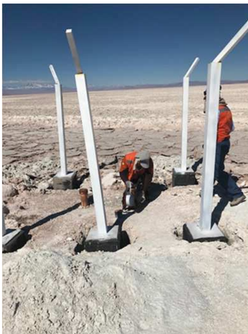
Figura 3: Medición de nivel piezométrico en Pozo L1-G4 del Sector de Soncor
