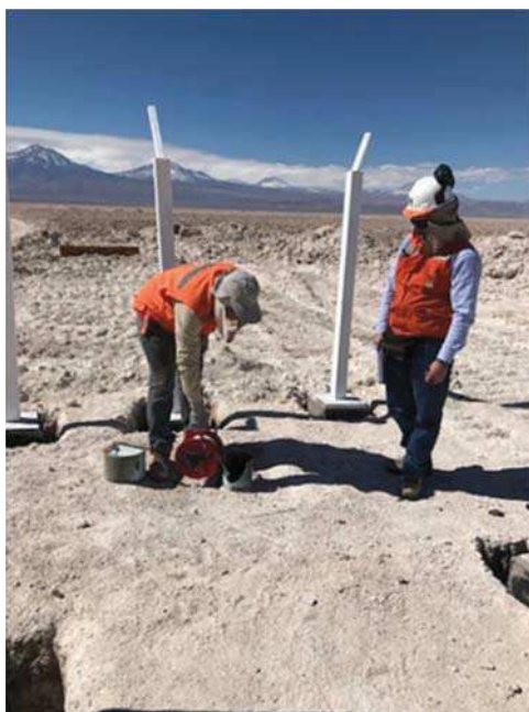
Figura 5: Medición de nivel piezométrico en Pozo L1-5 del Sector de Soncor
