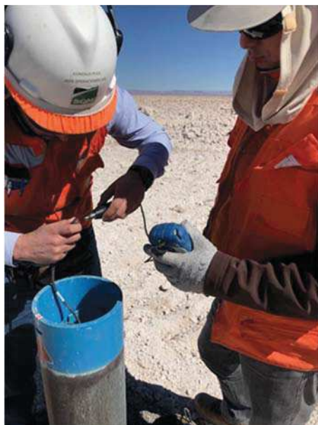
Figura 4: Medición de nivel piezométrico, en Pozo P1-2 del Sector de Soncor
