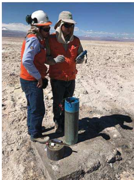
Figura 6: Medición de nivel piezométrico en Pozo P1-5 del Sector de Soncor
