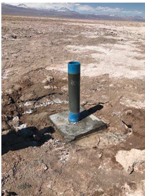
Figura 7: Medición de nivel piezométrico en Pozo RC-1 Sector de Soncor
